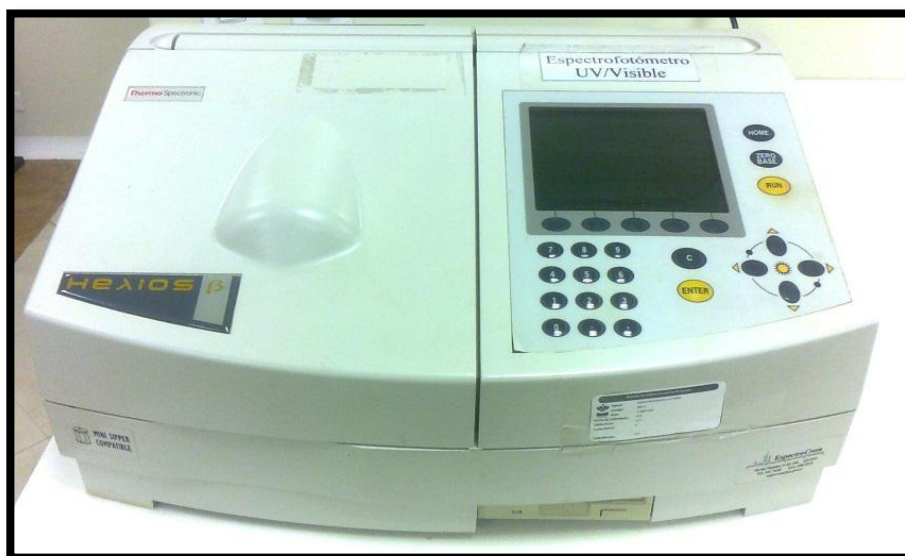
Fotografía 7: Espectrofotómetro de UV visible Helios \beta UVB091602. Fuente: Experimentación.
