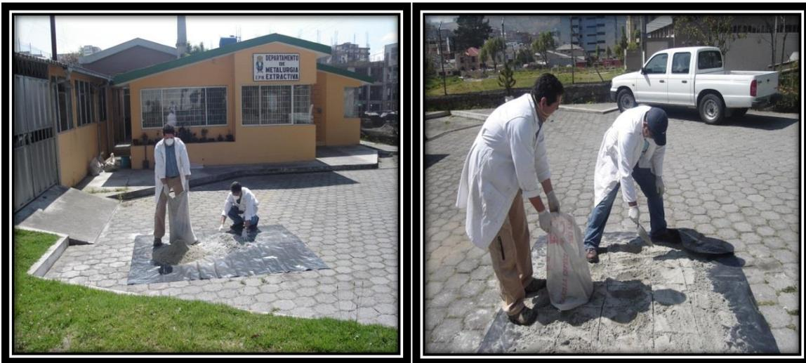
Figura 7. Homogenización de muestra
