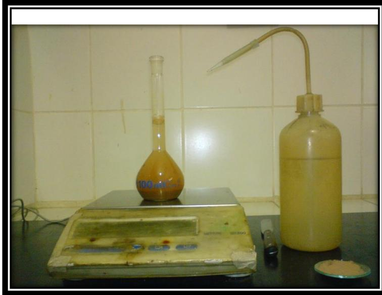
Figura 9. Materiales para la determinación del peso específico.
