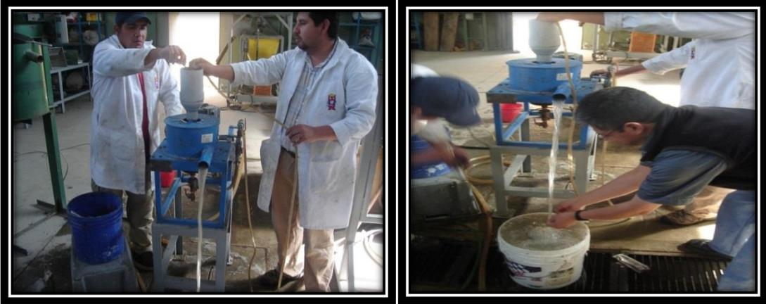
Figura 12. Concentrador centrífugo para oro modelo HY-G5
