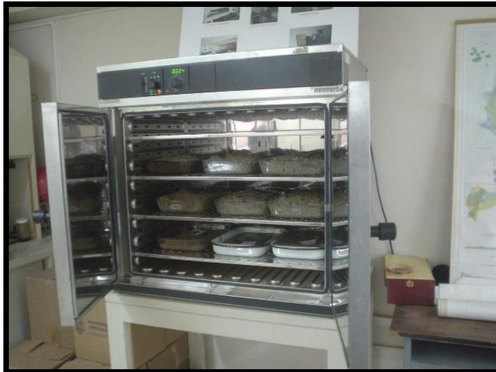
Figura8. Determinación de humedad
