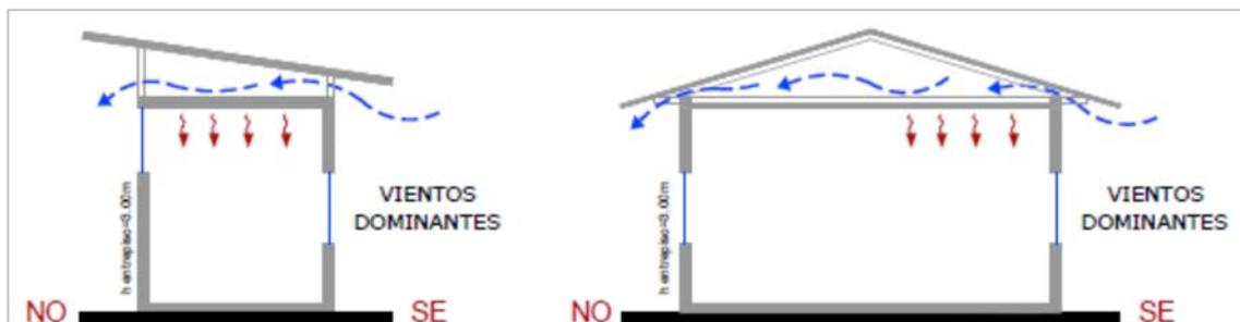
Figura 99. Las edificaciones de estos sitios en lo posible deben estar terminadas con cubierta inclinada y ventilada
