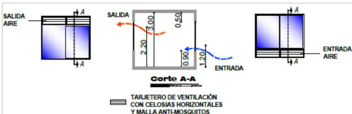
Figura 107. Detalles de la ventanas para ventilación cruzada.
