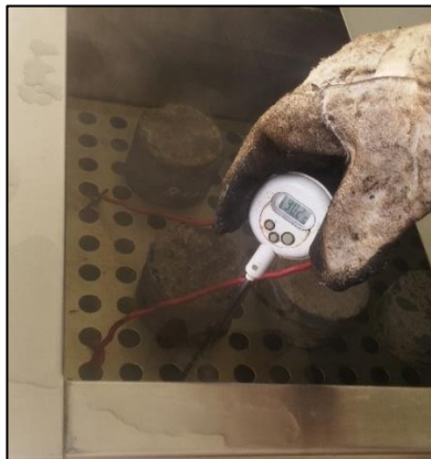
Figura 28. Núcleos de hormigón sumergidos en agua a ebullición.
