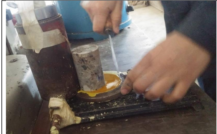
Figura Anexo 6. Refrentado del núcleo de hormigón.
