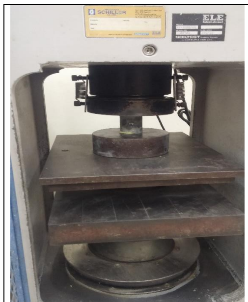
Figura Anexo 8. Ensayo de resistencia a la compresión del núcleo de concreto.
