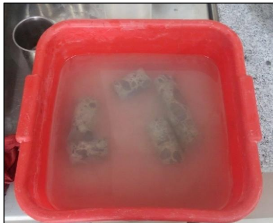
Figura 24. Curado de núcleos de hormigón.
