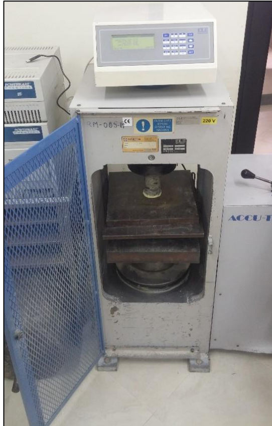
Figura 26. Prueba de resistencia a la compresión de un núcleo de hormigón.
