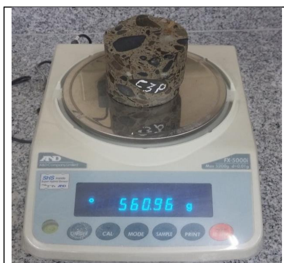
Figura Anexo 11. Masa de hormigón saturada de superficie seca después de inmersión y ebullición.
