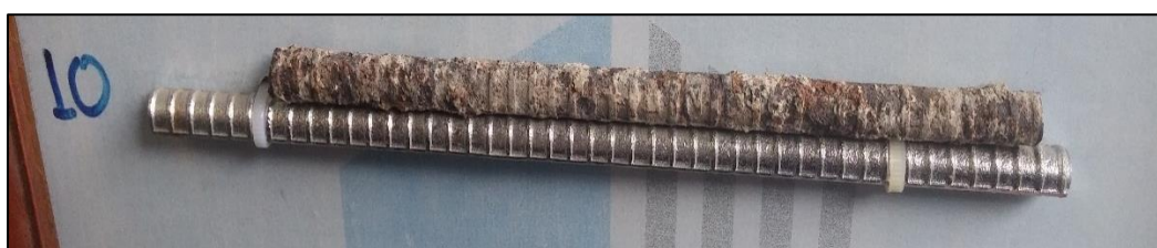
Figura 2. Varilla de acero corroída.
