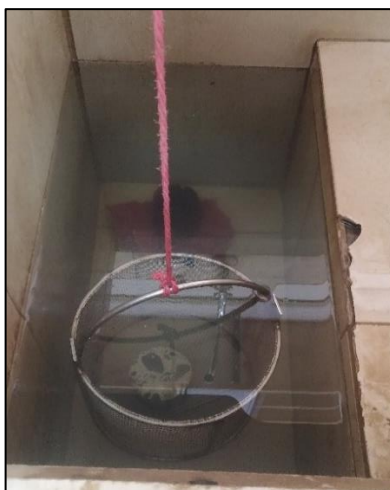
Figura 29. Núcleo de hormigón sumergido en agua.
