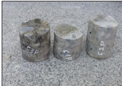
Figura 27. Núcleo individual de hormigón.
