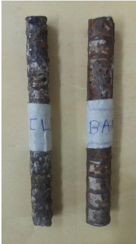
Figura 41. Estado de corrosión del acero de refuerzo.
