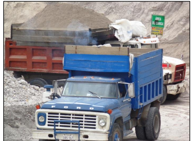
Fotos 5 y 6: Volquetes con capacidades de 8 a 10 m 3
