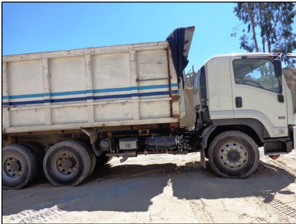
Fotos 5 y 6: Volquetes con capacidades de 8 a 10 m 3
