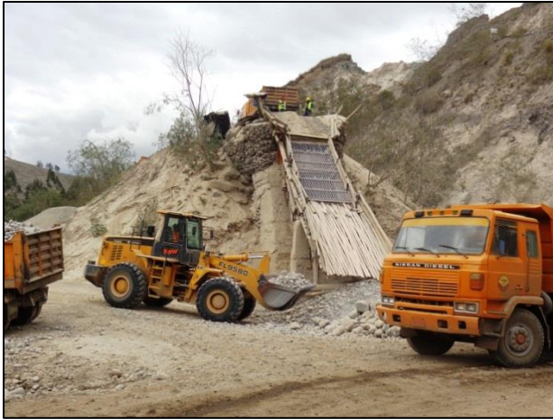
Fotos 3 y 4: Cargadoras Frontales (potencias netas de 120 a 220 HP)
