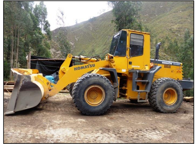
Fotos 3 y 4: Cargadoras Frontales (potencias netas de 120 a 220 HP)
