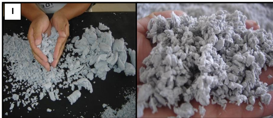
Imagen 29: Desmenuzado de material (partículas de celulosa de papel). Fuente: Elaboración Autor, 2016.
