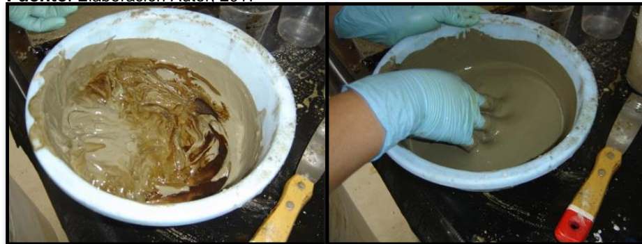
Imagen 56: Incorporación de aditivo a pasta de cemento.
