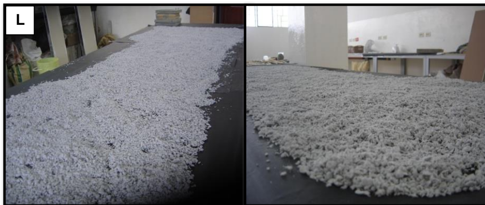
Imagen 31: Secado de las partículas de celulosa (L).
