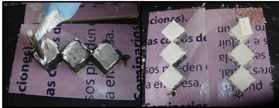
Imagen 70: Elaboración de muestras de yeso (muestras para pruebas a compresión).
