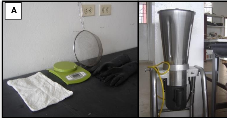
Imagen 25: Herramientas para obtener la celulosa de papel (partículas). Fuente: Elaboración Autor, 2016
