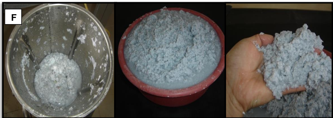
Imagen 26: Licuado de pulpa y colocación en tina. Fuente: Elaboración Autor, 2016
