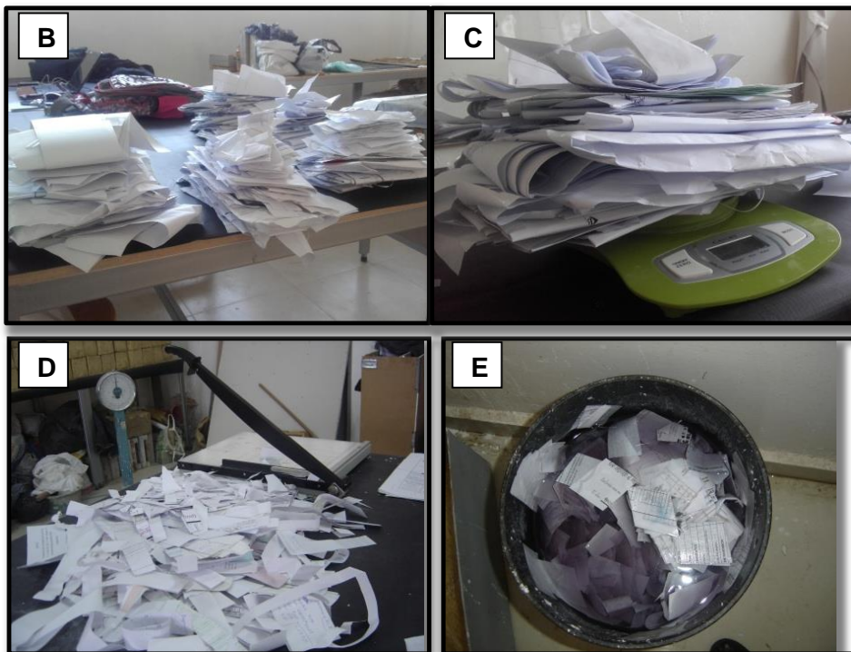
Imagen 24: (B) y (C) selección y peso de papel, (D) picado de papel, (E) remojo de papel Fuente: Elaboración Autor, 2016
