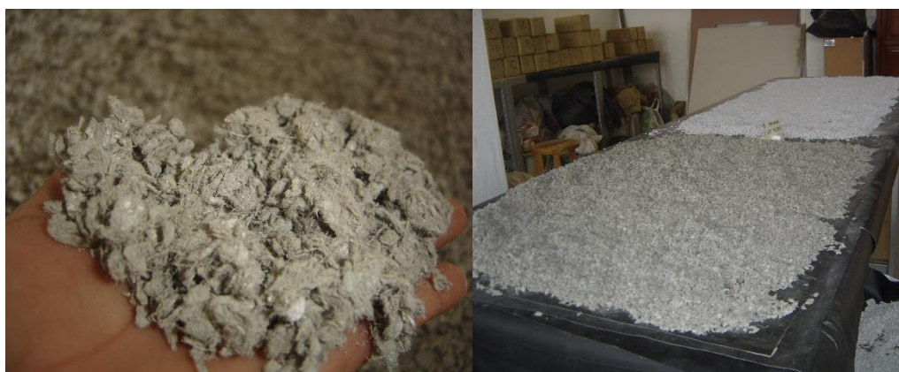
Imagen 89: Partículas de celulosa de cubetas de huevo y celulosa de papel boom.
