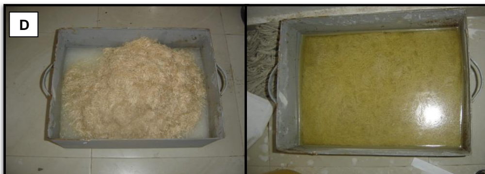
Imagen 38: Sumersión y reposo de la fibra en solución de Hidróxido de calcio (D).
