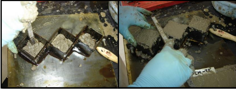
Imagen 65: Vaciado de mezcla en molde y compactación (muestras para pruebas a compresión).
