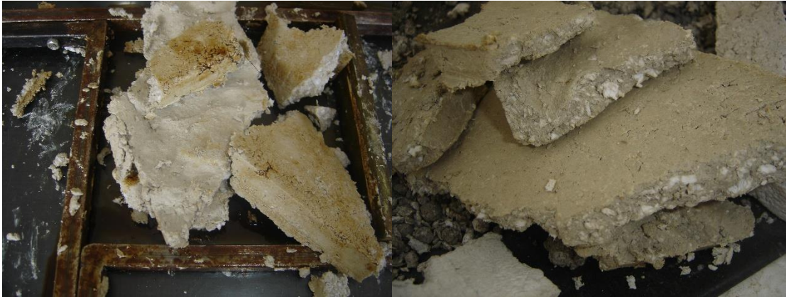
Imagen 92: Apariencia de partículas de celulosa de papel con cemento y yeso. Fuente: Autor, 2016
