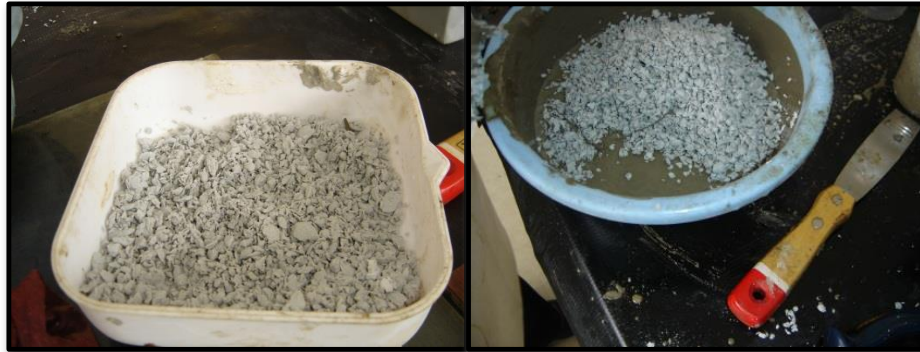
Imagen 58: Incorporación de la celulosa de papel en pasta de cemento. Fuente: Elaboración Autor, 2017
