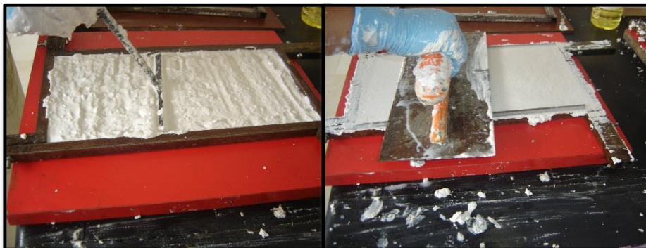
Imagen 71: Elaboración de muestras de yeso (muestras para pruebas a flexión).
