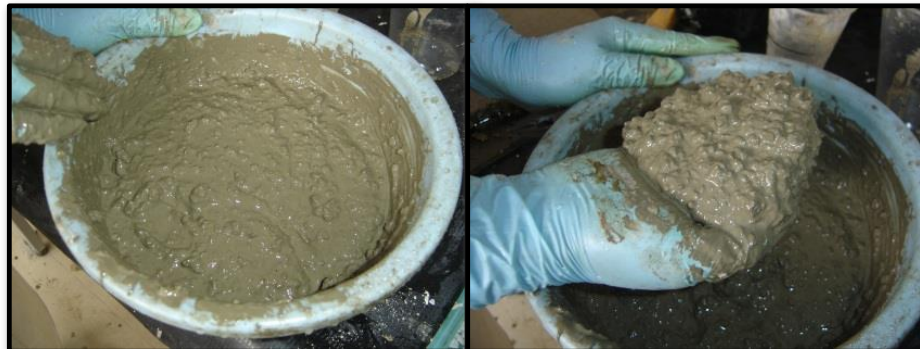
Imagen 59: Batido de pasta de cemento con partículas de celulosa de papel. Fuente: Elaboración Autor, 2017
