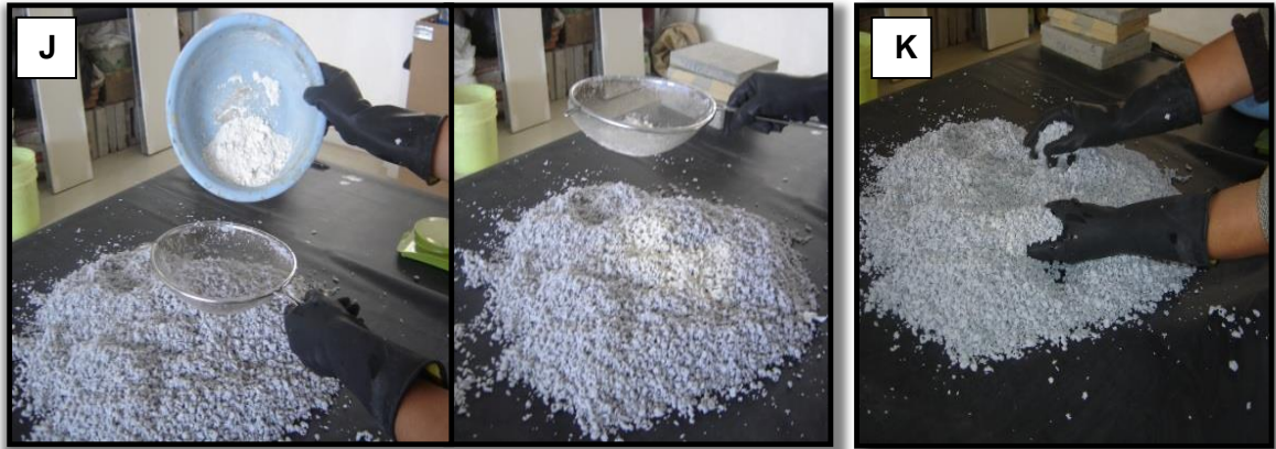
Imagen 30: Aplicación de cal hidratada sobre partículas de celulosa (J), Mezclado de cal y partículas de celulosa (K).
