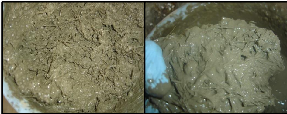
Imagen 64: Batido de mezcla (pasta de cemento, celulosa de papel y fibra de Abacá)
