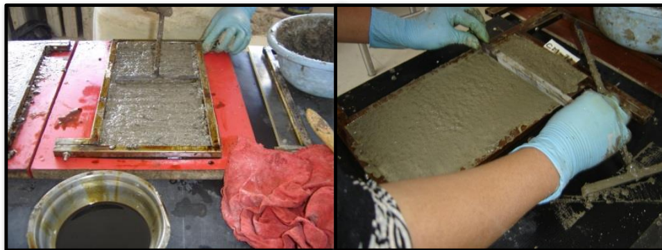
Imagen 68: Compactación y pulido de cara superior de muestras de cemento.
