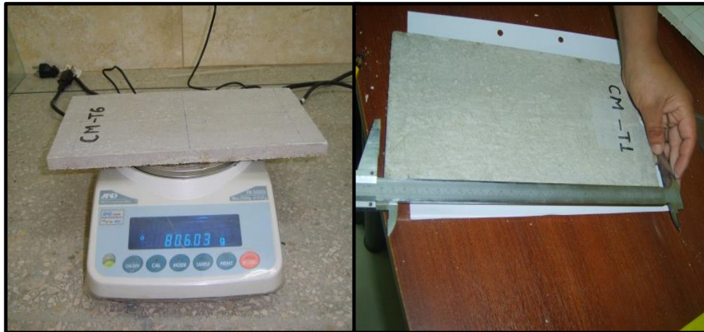
Imagen 76: Peso y medición de muestras para ensayo de densidad. Fuente: Elaboración Autor, 2017
