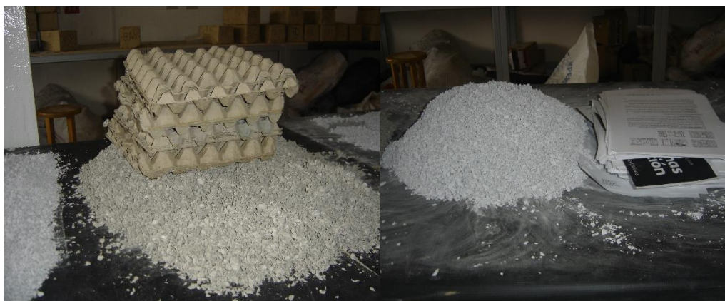
Imagen 88: Celulosa de papel obtenida de cubetas de huevo, celulosa de papel obtenida de papel boom.
