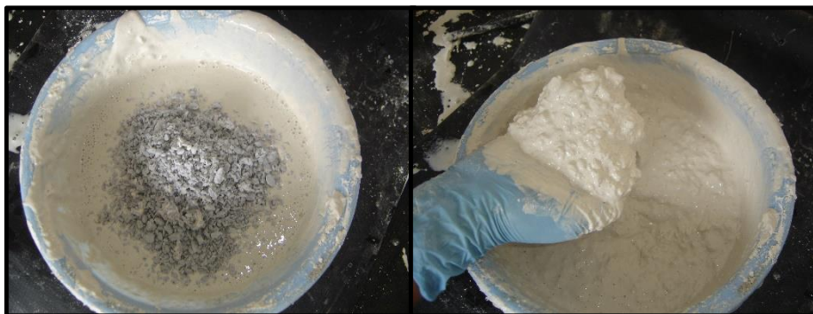
Imagen 60: Batido de pasta de yeso con partículas de celulosa de papel. Fuente: Elaboración Autor, 2017
