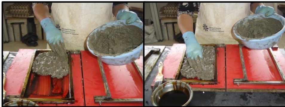
Imagen 67: Vaciado de mezcla en molde (muestras para pruebas a flexión).
