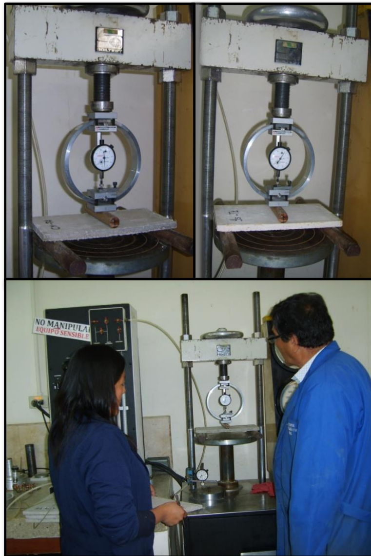
Imagen 73: Ensayo de resistencia a la flexión. Fuente: Elaboración Autor, 2017
