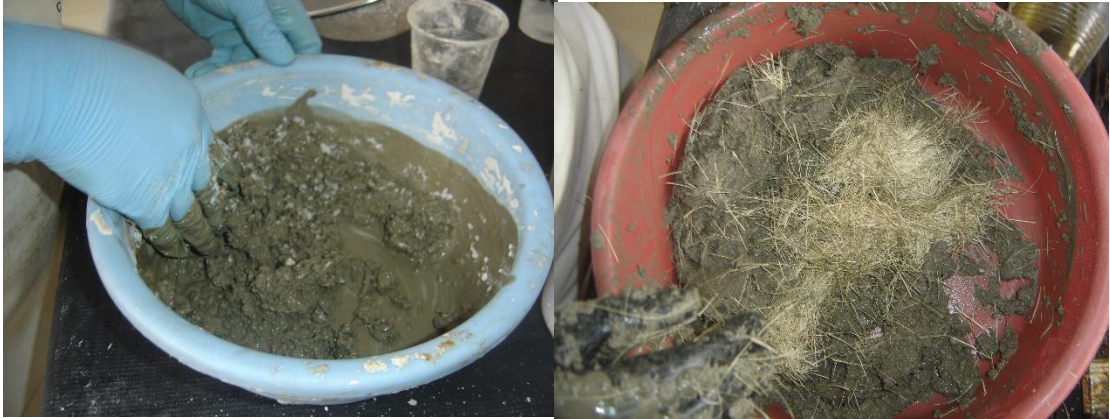
Imagen 94: Combinaciones de cemento y celulosa de papel, combinación de cemento celulosas de papel y fibra de Abacá. Fuente: Autor, 2016
