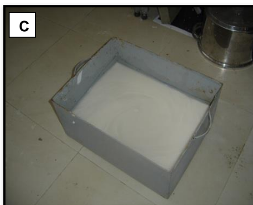
Imagen 37: Preparación de solución de Hidróxido de calcio (C).
