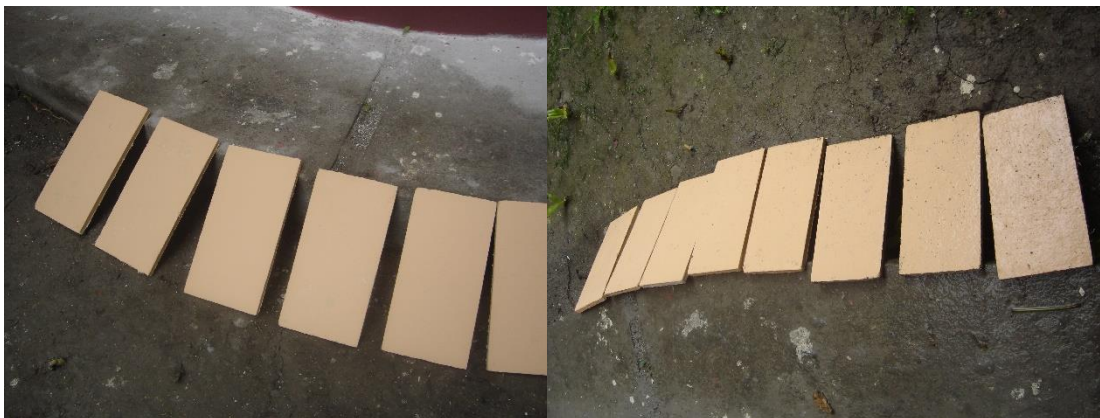
Imagen 96: Muestras de cemento y yeso CM-T1, CM-T4, YS-T2 y YS-T5 pintadas con pintura para exteriores, expuestas al sol y lluvia por dos meses. Fuente: Autor, 2016
