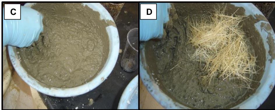
Imagen 63: Pasta de cemento y celulosa de papel(C), incorporación de fibra de Abacá a pasta de cemento con partículas de celulosa de papel (D).
