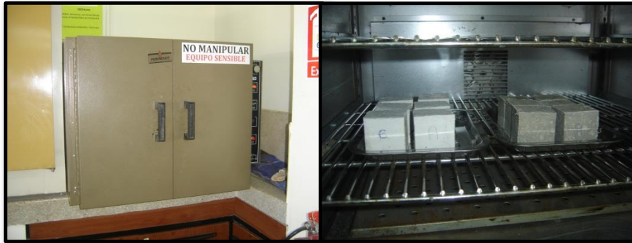
Imagen 78: Colocación de muestras en horno eléctrico. Fuente: Elaboración Autor, 2017
