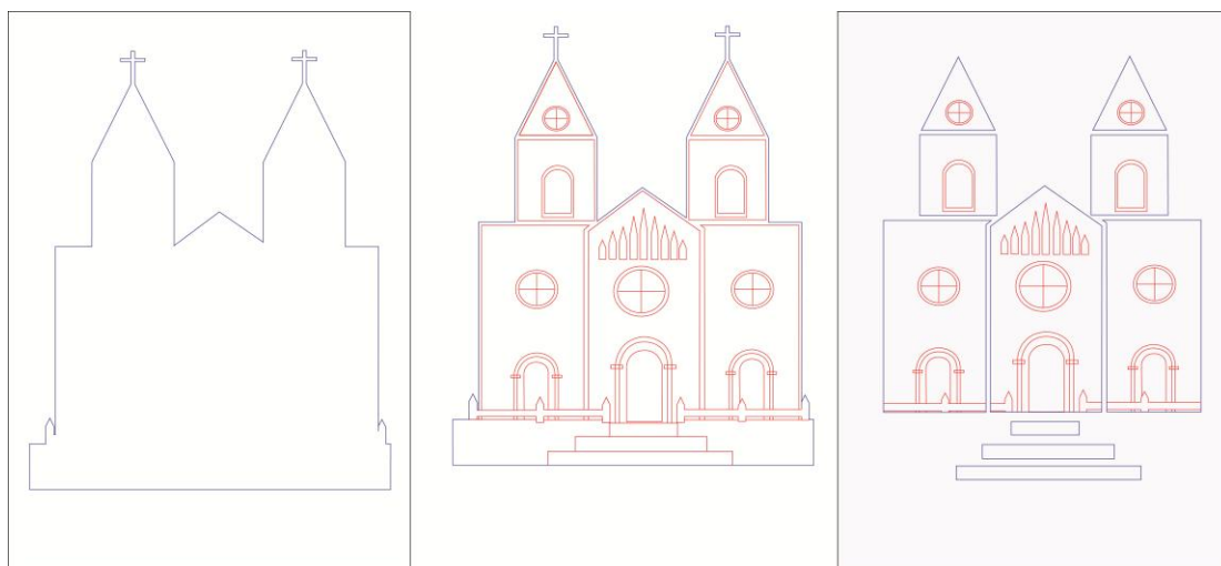
Figura 55 Iglesia de Santo Domingo, seccionada paso a paso para corte y armado.
