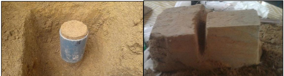
Figura 8. Muestras inalteradas.
