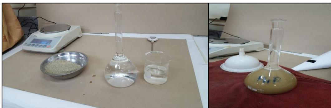
Figura 16. Gravedad específica de los sólidos.
