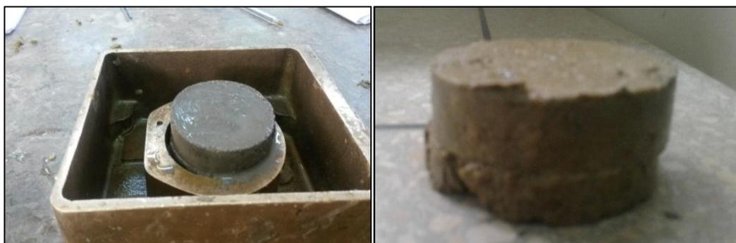
Figura 17. Ensayo de corte directo.
