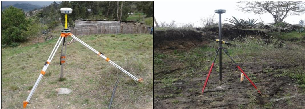
Figura 10. Estación base y controlador Trimble R6 en la lectura de coordenadas.
