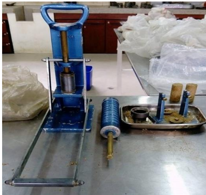
Figura 14. Preparación especímenes para ensayo triaxial.
