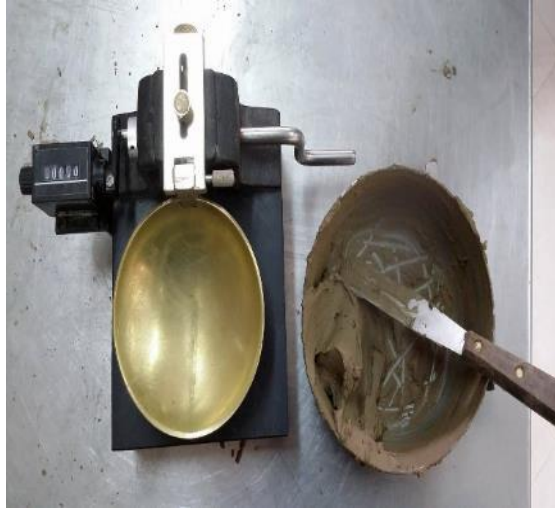
Figura 12. Límite líquido – pie de talud. Fuente: El autor. Elaboración: El autor.
