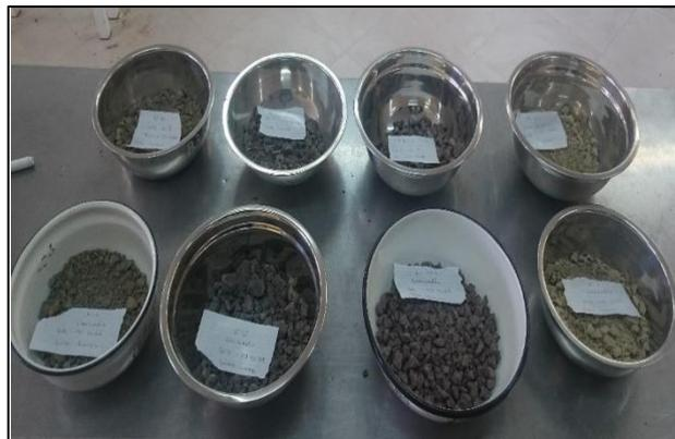
Figura 11: Muestras para ensayo de granulometría
