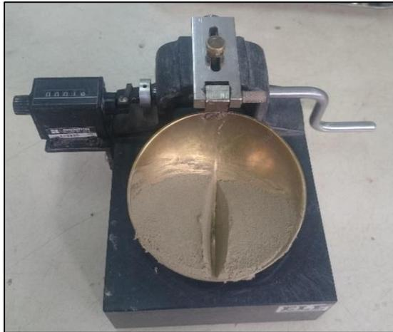
Figura 12: Ensayo de límite líquido.
