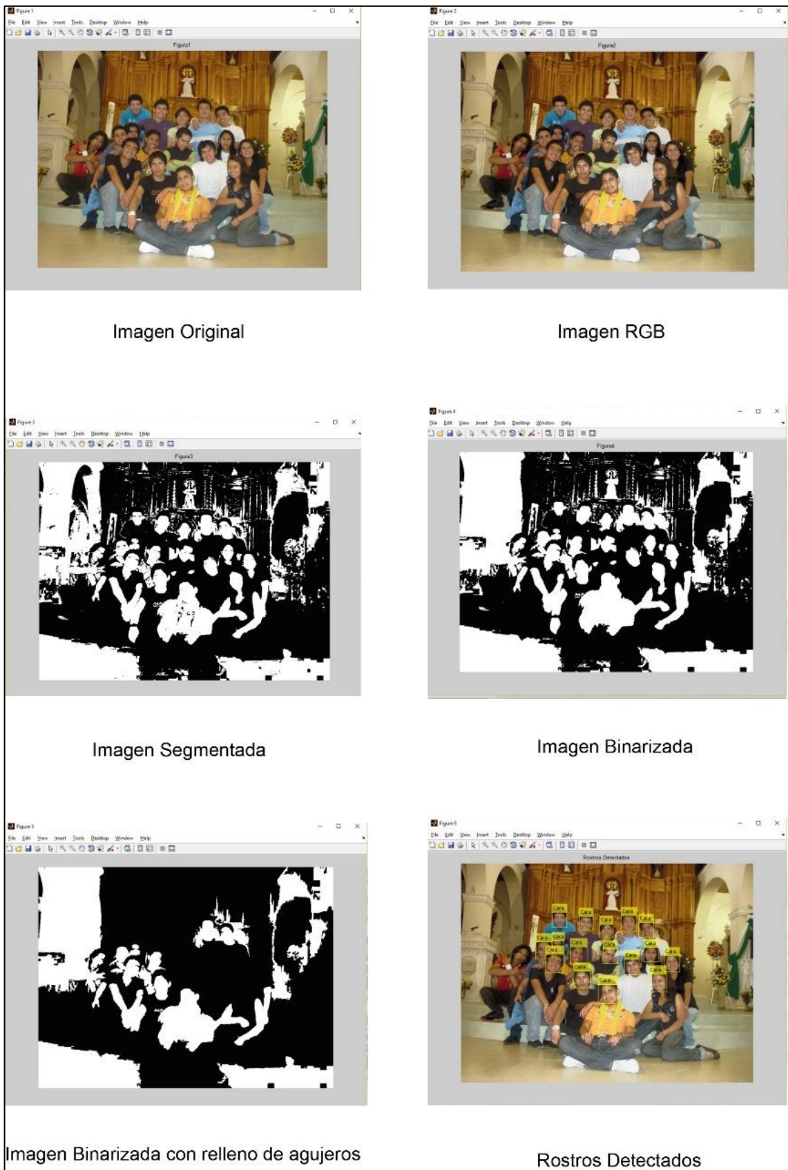
Figura 26. Proceso de una imagen para Detección y Conteo de Rostros.
