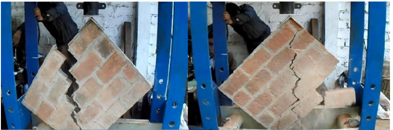
Figura 56. Falla ladrillo Tipo 2.
