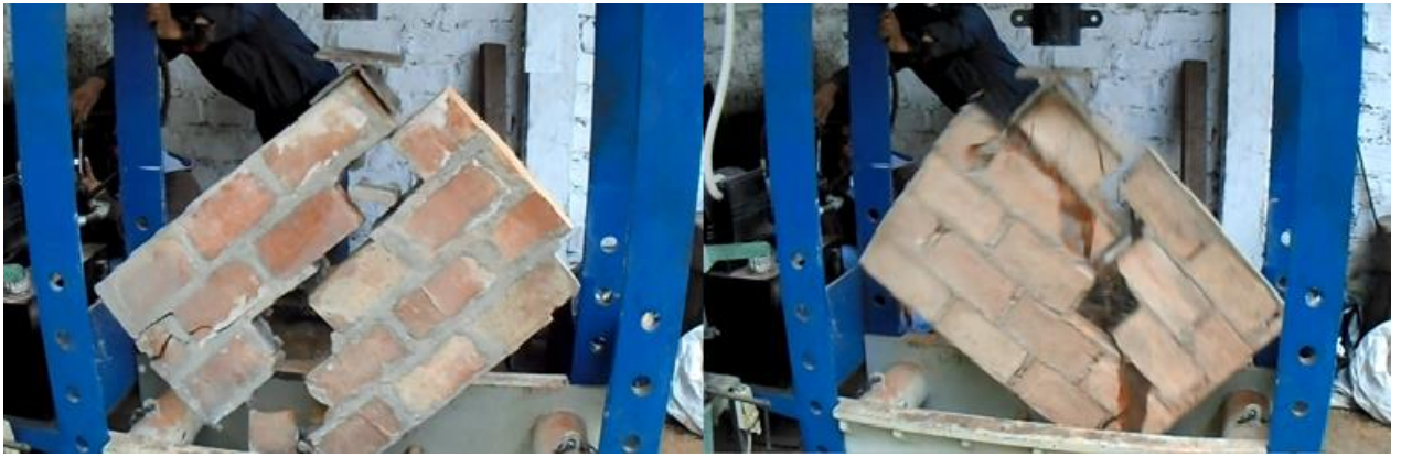
Figura 55. Falla ladrillo Tipo 1.
