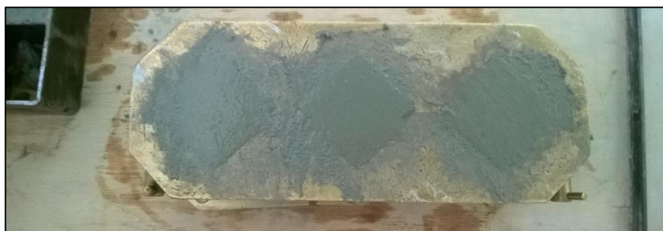
Figura 40. Ensayo de cubos de mortero.
