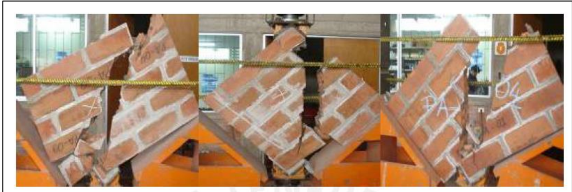
Figura 6. Falla típica en muretes de arcilla.
