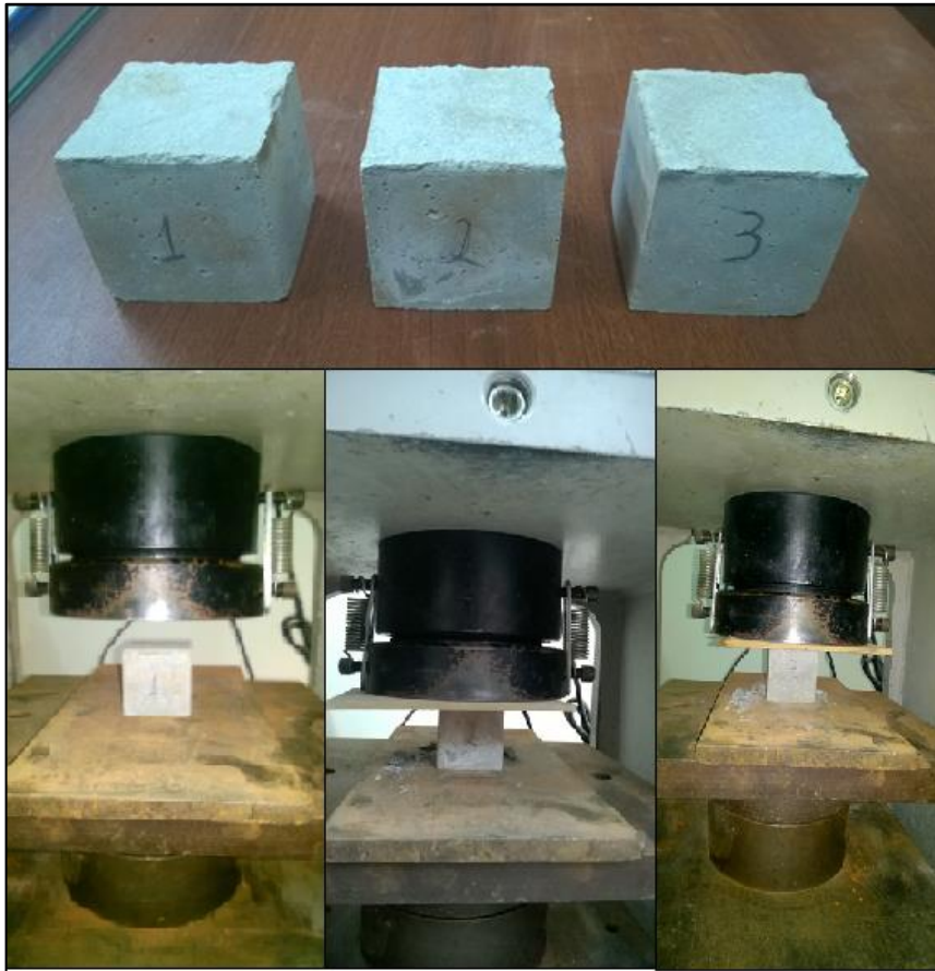
Figura 43. Ensayo de compresión de cubos de mortero.
