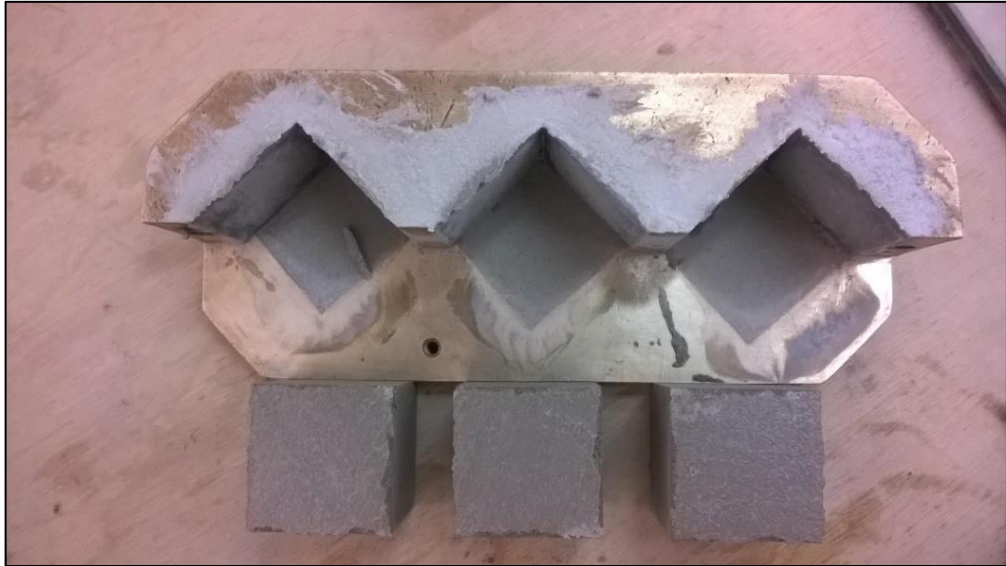
Figura 41. Desencofrado de cubos de mortero.
