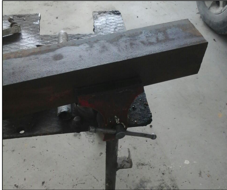
Figura 51. Confección de cabezales de aplicación de carga.
