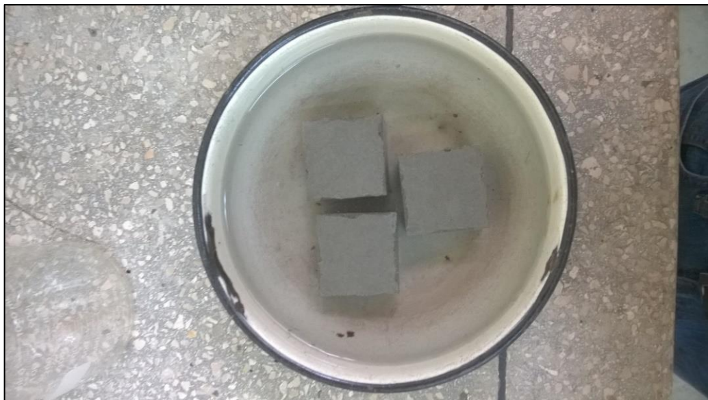
Figura 42. Curado de especímenes de cubos de mortero.
