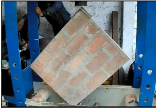
Figura 53. Ensayo de compresión diametral.
