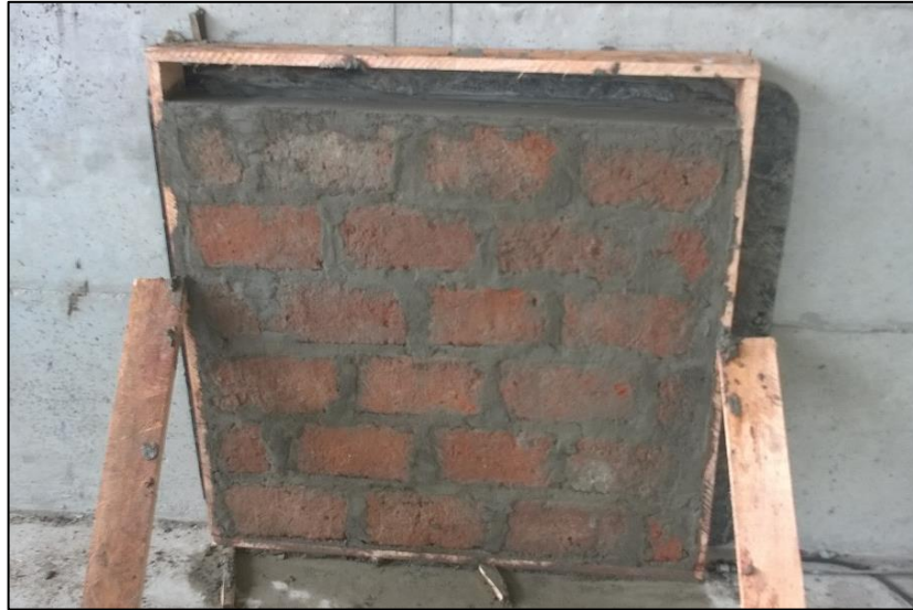
Figura 27. Construcción de pared modelo.
