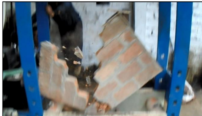
Figura 54. Ensayo de compresión diametral.
