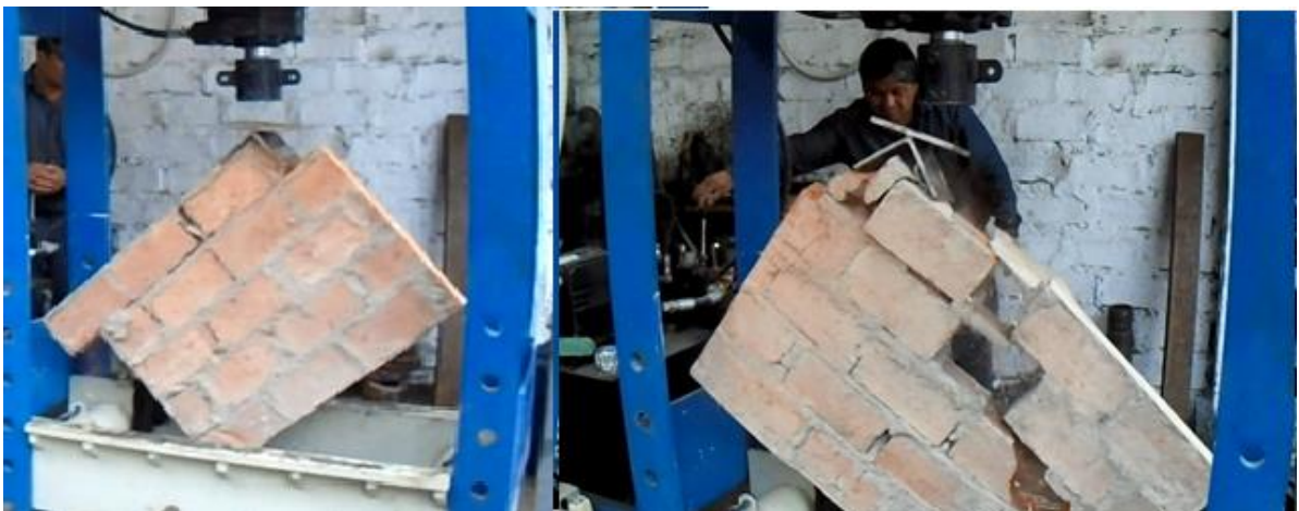
Figura 57. Falla ladrillo Tipo 3.
