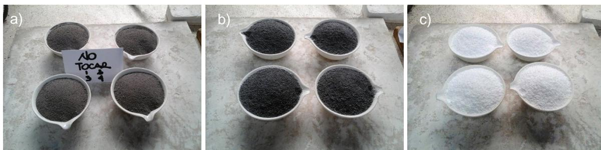
Figura 40. a) CHM calcinada a 450° C. b) CHM calcinada a 700° C. c) CHM calcinada a 1000° C.
