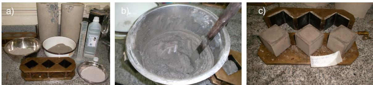
Figura 48. a) Materiales a utilizar, variación en la cantidad de CHMC. b) Mezcla en el tazón de la mezcladora. c) Matriz cementicias fraguada sin adición de CHCM, Cementante pura.
