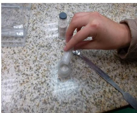
Figura 38. Colocación de muestra en la pistola de eflorescencia.
