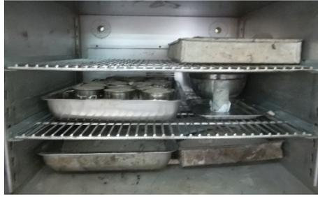
Figura 44. Recipiente de la arena en el horno, secado durante 24 horas.
