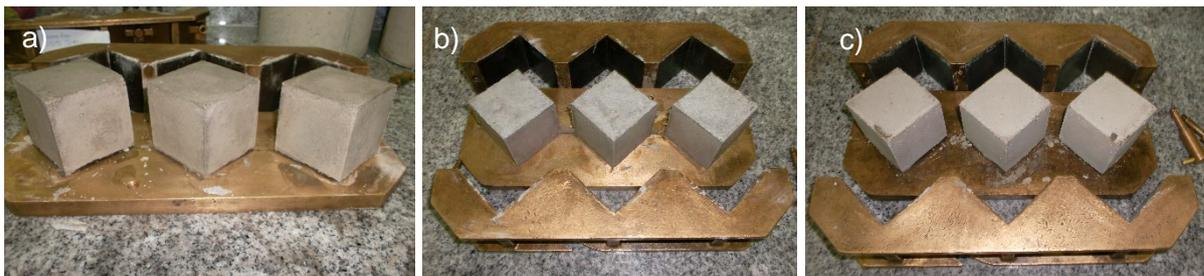
Figura 49. a) Matriz cementicias fraguada con adición de CHCM a 450° C. b) Matriz cementicias fraguada con adición de CHCM a 700° C. c) Matriz cementicias fraguada con adición de CHCM a 1000° C.
