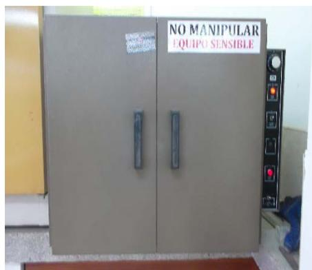
Figura 42. Horno para secar material (arena) por 24 horas.
