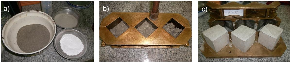
Figura 55. a) Pesaje de materialidad. b) Relleno de Matrices Cementicias con 32 golpes con el apisonador y en 3 capas. c) Desmolde de Matrices Cementicias a las 24 horas de formarse la misma. Fuente: Reibán, D. 2017. Elaborado por: Reibán, D. 2017.
