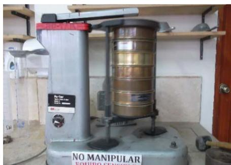
Figura 45. Serie de tamices en la máquina tamizadora RO-TAP. Fuente: Reibán, D. 2017.
