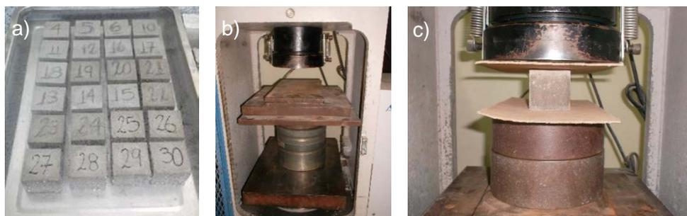
Figura 56. a) Matrices cementicias sumergidas en agua b) Armado de máquina Triaxial Accu Tek con placas y alzas de acero para roturas a la compresión (kN). c) Rompimiento de Matriz Cementicia a la compresión.
