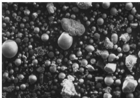
Figura 16. Micrografía SEM de una ceniza volante.
