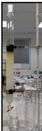
**Figura 9.** Columna cromatográfica del extracto de Metanol
