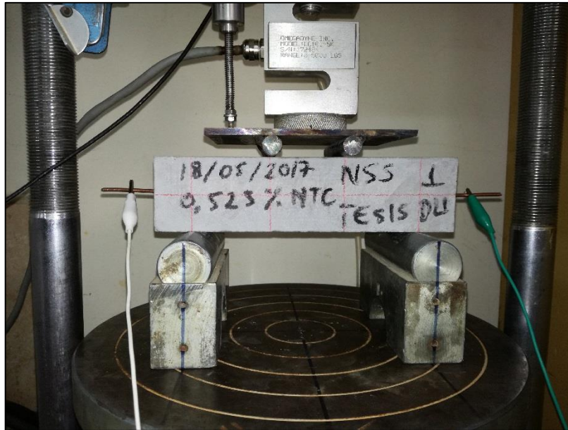
Figura 33. Equipo Versa Tester adecuado con placa de carga de wt=595,45 g. Fuente: El Autor Elaboración: El Autor
