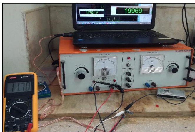
Figura 36. Circuito de medición de variación de voltaje calibrado. Fuente: El Autor Elaboración: El Autor
