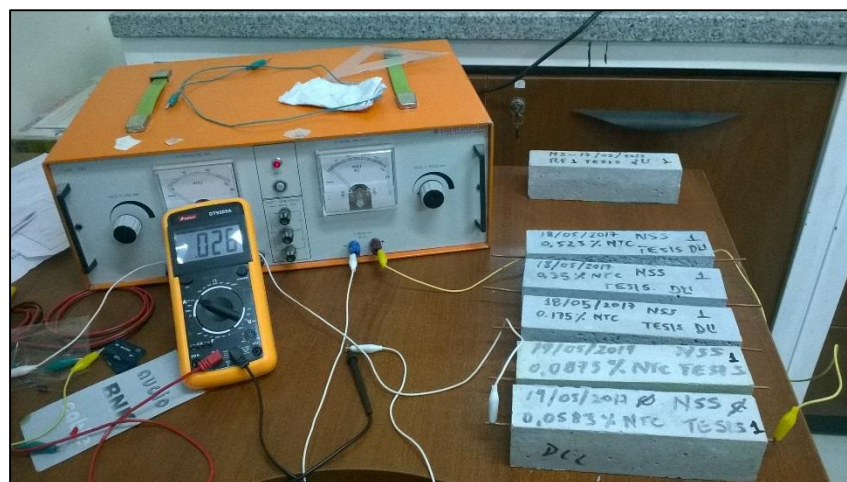
Figura 31. Circuito para la medición, (V.c.c) Voltaje de corriente continua, (mA) Miliamperios, (Espécimen) Probeta prismática en forma de vigueta de (5x5x20) cm.
