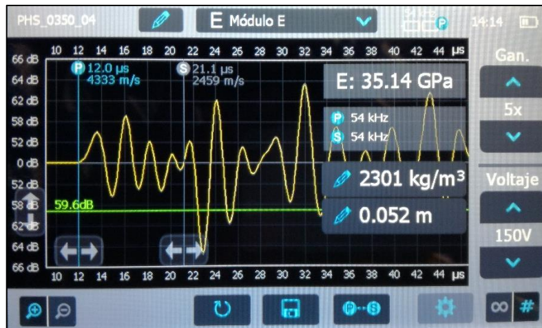
Figura 40. Pantalla Equipo Pundit PI-200, Determinación del Módulo de Elasticidad Fuente: El Autor Elaboración: El Autor
