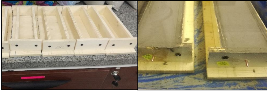
Figura 22. Preparación de los moldes. Fuente: El Autor Elaboración: El Autor
