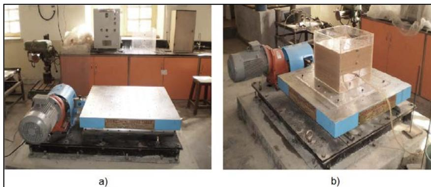
Figura 33. Equipo de ensayo mesa vibratoria.
