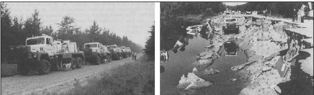
Figura 21. Izquierda: tren de vehículos de prospección geotécnica. Derecha: Licuefacción inducida por las placas de vibrosis en arenas saturadas.
