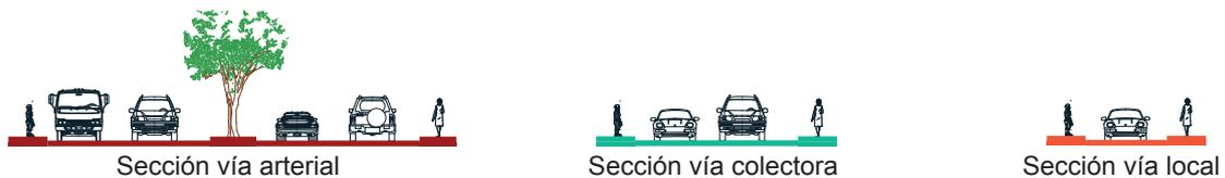
Figura 85. Sección de vías.
