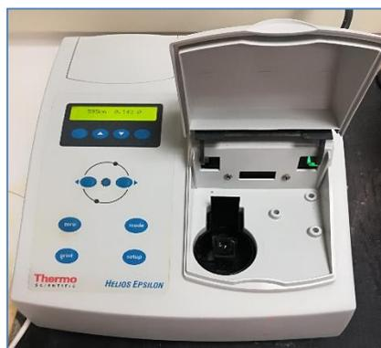
**Figura 9.13.** Determinación de carbohidratos por espectrofotetría UV visible
