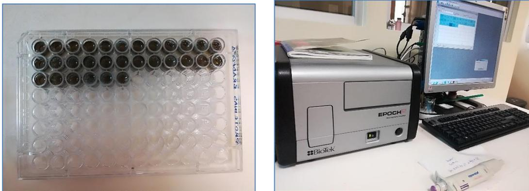
**Figura 9.12.** Determinación de proteínas por el método de Bradford
