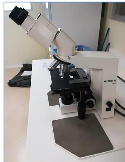
**Figura 9.7.** Microscopio para recuento de bacterias
