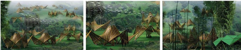
La estructura modular es de tipo radial, pero utiliza formas lineales que se conforman de una materialidad liviana y de facil ensamble, ademas se puede generar formas curvas con la disposición de los elementos lineales.
