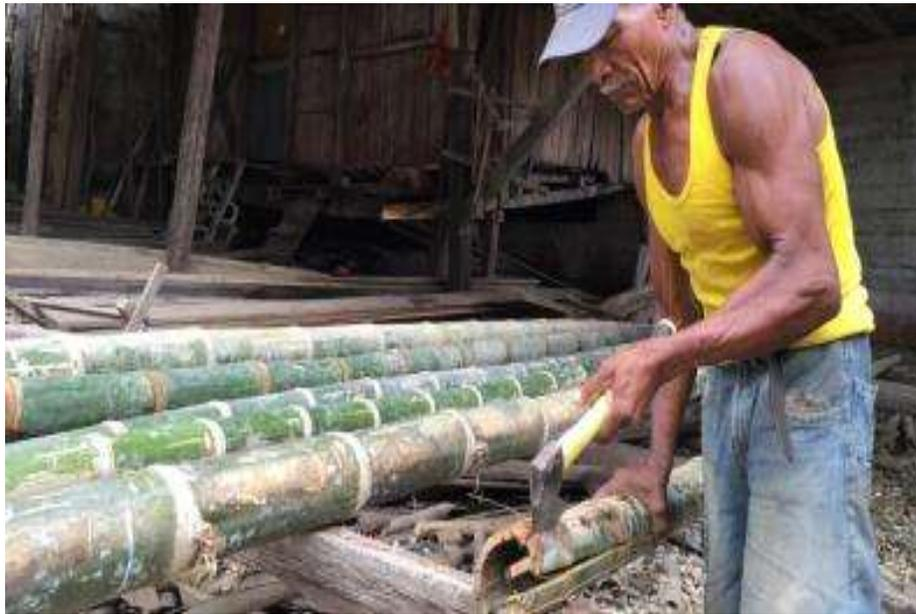
**Ilustración 1-31.-** El nudo detiene la rotura longitudinal de la guadua.
