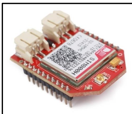
Figura 3.4.8. Módulo GPRSbee. Fuente: Véase [28]. Elaboración: Véase [28].
