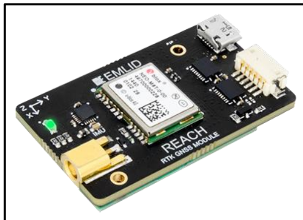
Figura 3.4.7. Módulo Reach RTK GNSS .
