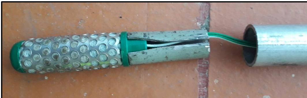
Figura 4.6.14. Acoplamiento del sensor de humedad a un tubo galvanizado como guía de protección para el cable.
