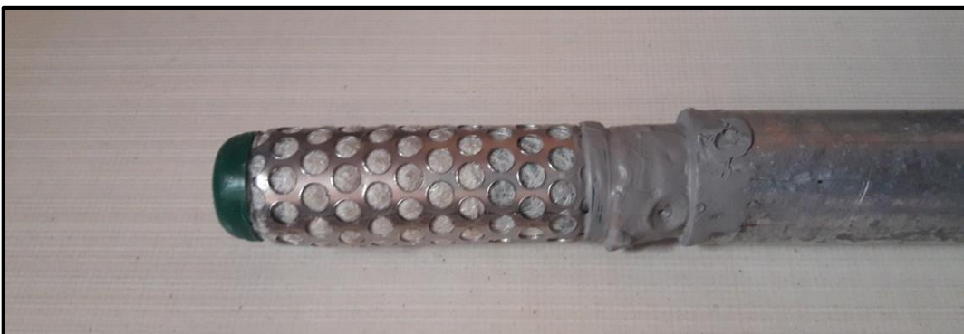
Figura 4.6.15. Unión del sensor de humedad al tubo galvanizado mediante pegamento impermeable.
