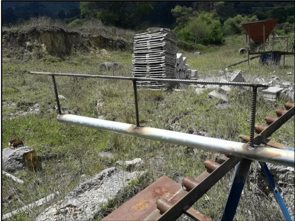
Figura 4.6.5. Acoplamiento de una varilla en paralelo a la estructura del nodo para la medición del punto de georreferenciación.
