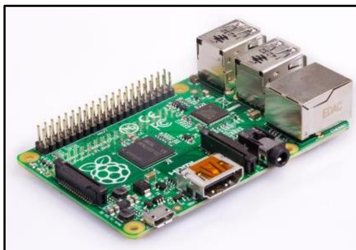
Figura 2.5.1. Tarjeta Raspberry Pi modelo B V1.1. Fuente: Véase [31]. Elaboración: Véase [31].
