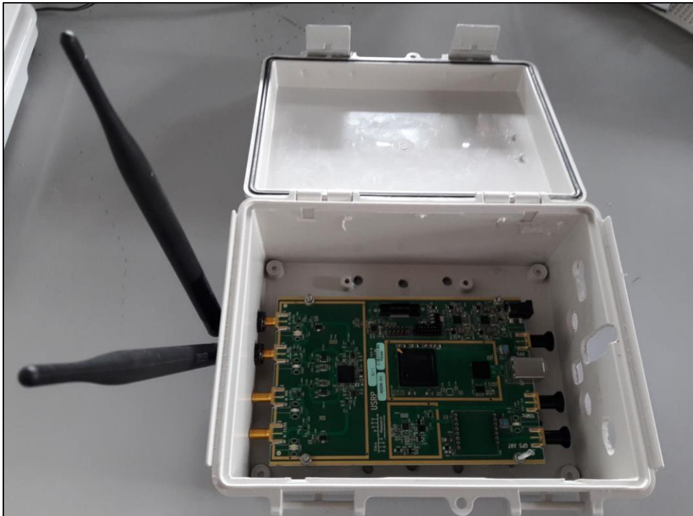
Figura 3.31 Ensamble de USRP B210 en la caja HI BOX IP67.
