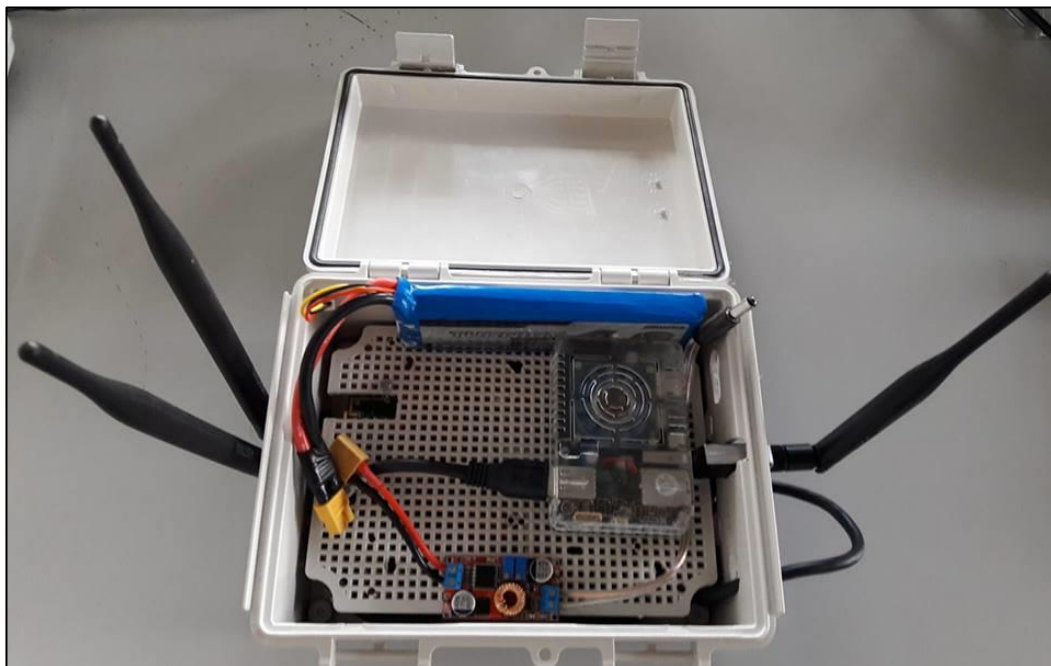
Figura 3.32 Ensamble de dispositivos en la caja HI BOZ IP67.
