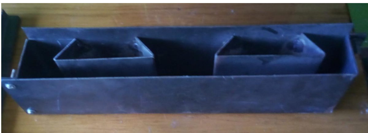
Figura 77: molde metálica armado
