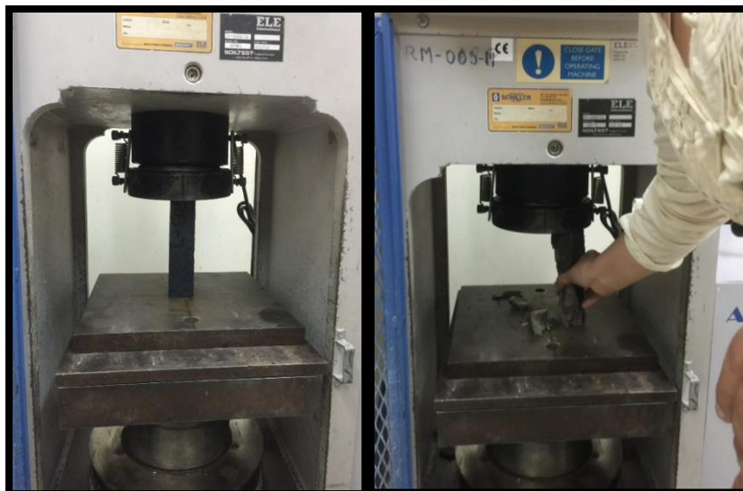
Figura 109: Máquina con probetas para ensayo a compresión Fuente: Caivinagua Samaniego, Danny Israel; fecha de actualización 15 de octubre 2017 Elaboración: Caivinagua Samaniego, Danny Israel
