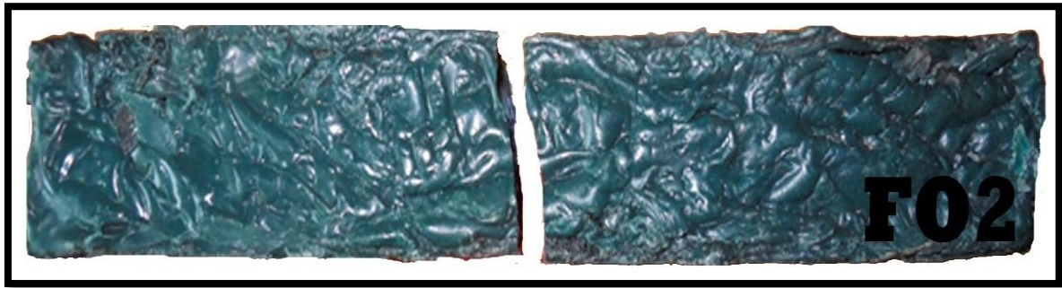
Figura 97: Probeta F02/Cara frontal/Falla a flexión
