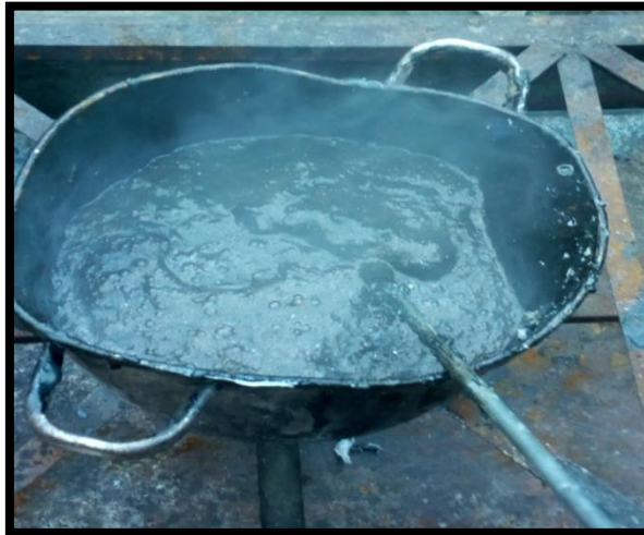
Figura 86: PET derretido, hecho liquido
