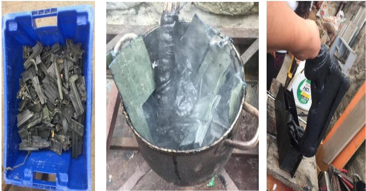
Figura 116: Colocación de la masa en el molde Fuente: Caivinagua Samaniego, Danny Israel Elaboración: Caivinagua Samaniego, Danny Israel
