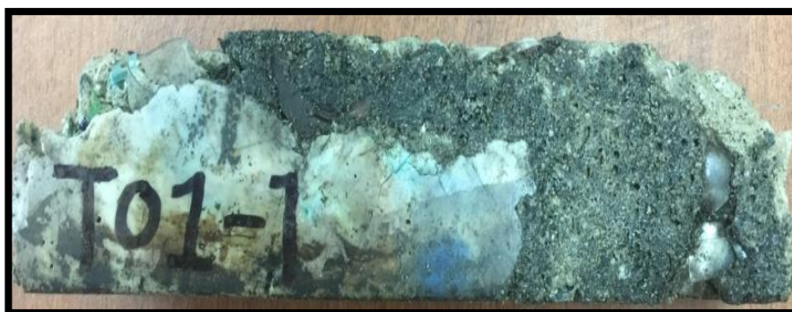
Figura 103: Probeta T01-1 /Cara frontal/Falla a compresión.
