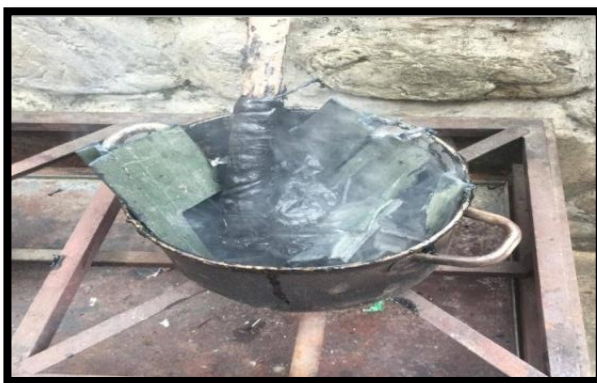
Figura 88: Cocción del polímero PEAD Fuente: Caivinagua Samaniego, Danny Israel; fecha de actualización 15 de agosto del 2017 Elaboración: Caivinagua Samaniego, Danny Israel
