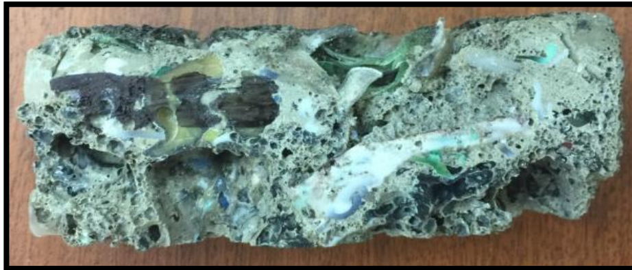
Figura 106: Probeta T02-2 /Cara frontal/Falla a compresión Fuente: Caivinagua Samaniego, Danny Israel; fecha de actualización 05 de octubre de 2017 Elaboración: Caivinagua Samaniego, Danny Israel
