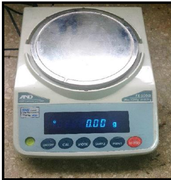
Figura 70: Balanza digital /AND/FX-5000i Fuente: Caivinagua Samaniego, Danny Israel; fecha de actualización: 03-10-2017 Elaboración: Caivinagua Samaniego, Danny Israel Loja
