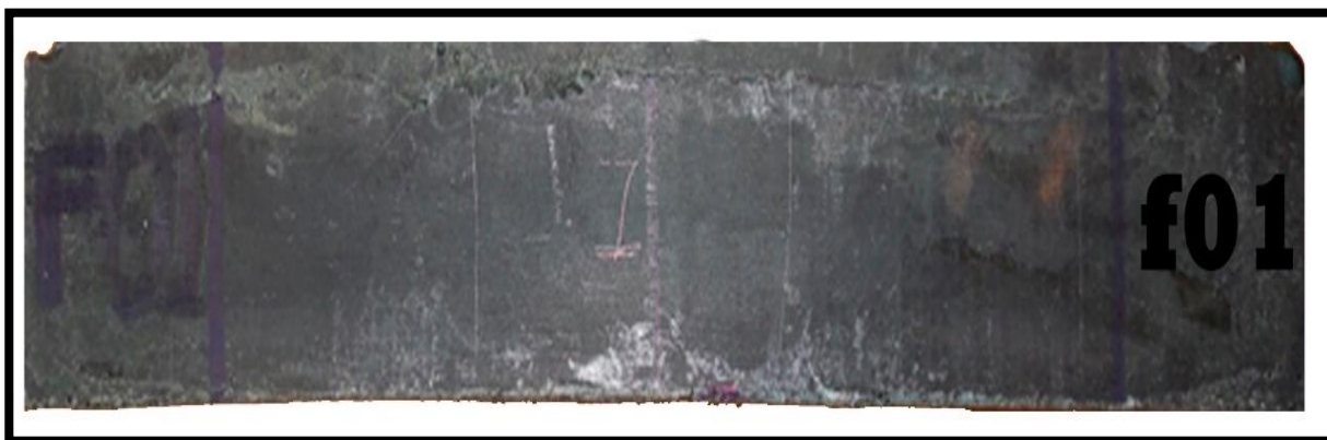
Figura 93: probeta de PEAD para ensayo a flexión
