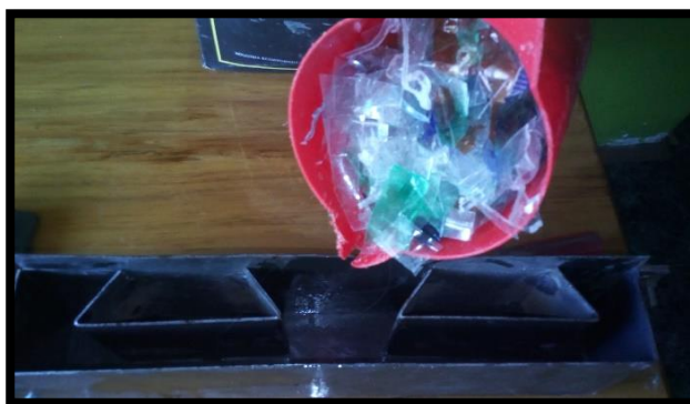
Figura 82: Colocación de PET en el molde Fuente: Investigación de Campo Elaboración: Caivinagua Samaniego, Danny Israel
