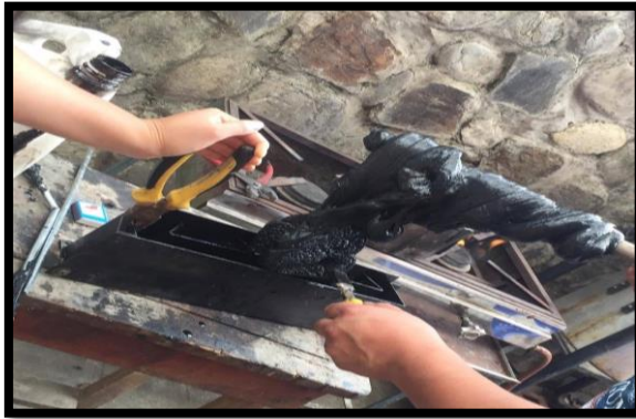
Figura 89: Colocación de la masa PEAD en el molde
