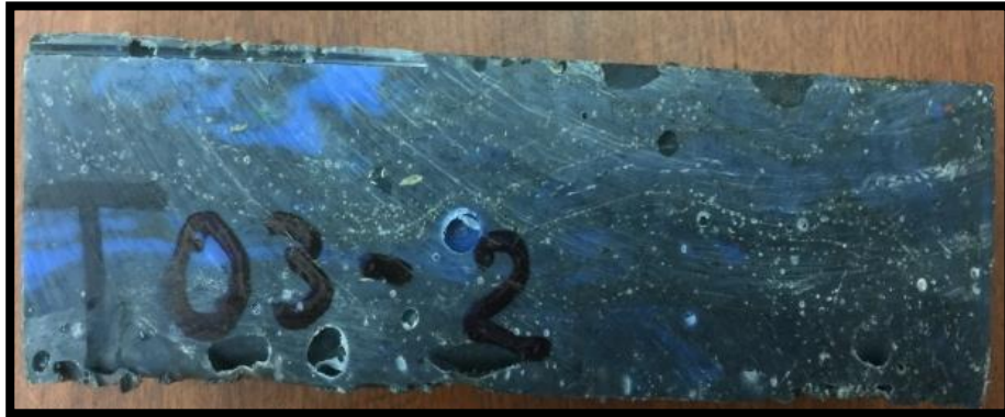
Figura 108: Probeta T03-2 /Cara frontal/Falla a compresión Fuente: Caivinagua Samaniego, Danny Israel; fecha de actualización 05 de octubre de 2017 Elaboración: Caivinagua Samaniego, Danny Israel
