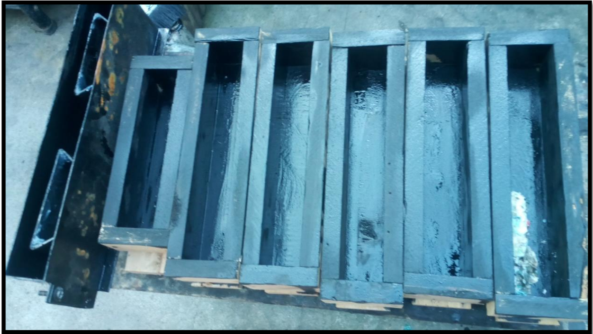
Figura 92: Moldes de madera para probetas a flexión y compresión lubricadas Fuente: Caivinagua Samaniego, Danny Israel; fecha de actualización 03 de octubre del 2017 Elaboración: Caivinagua Samaniego, Danny Israel
