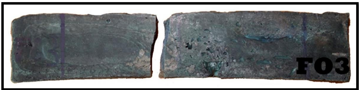
Figura 98: Probeta F03/Cara frontal/Falla a flexión
