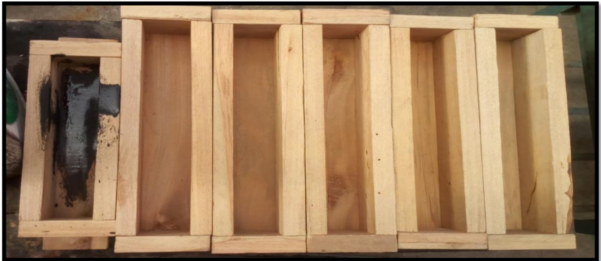
Figura 91: Moldes de madera para probetas a flexión y compresión
