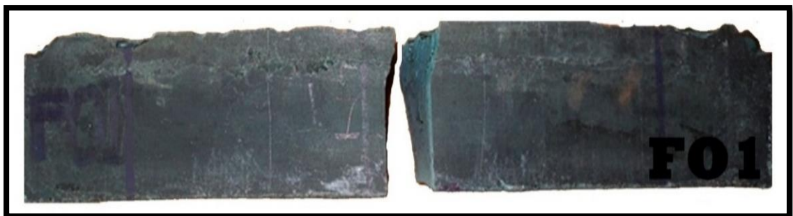
Figura 96: Probeta F01/Cara frontal/Falla a flexión
