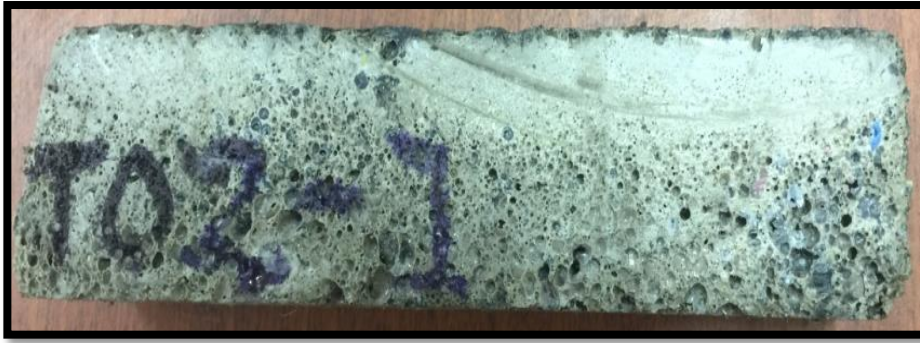
Figura 105: Probeta T02-1 /Cara frontal/Falla a compresión Fuente: Caivinagua Samaniego, Danny Israel; fecha de actualización 05 de octubre de 2017 Elaboración: Caivinagua Samaniego, Danny Israel
