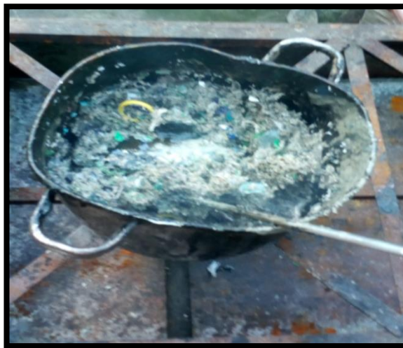
Figura 85: Colocación de PET en la olla de aluminio
