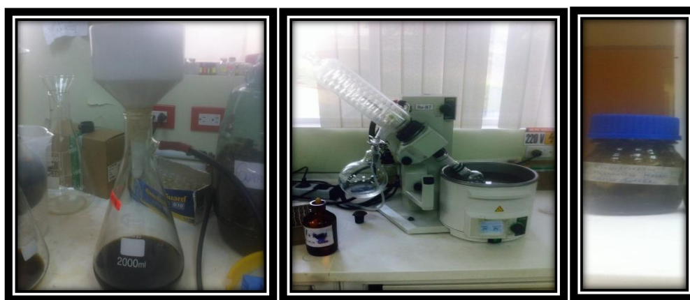
Figura 6. Obtención del Extracto metanólico total: Filtración, Concentración y Extracto
