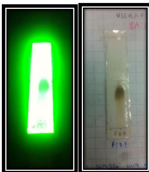
Figura 14. CCF de la purificación de la fracción VLCRAF7.1 (8A:2M): Luz UV 254 nm y revelada
