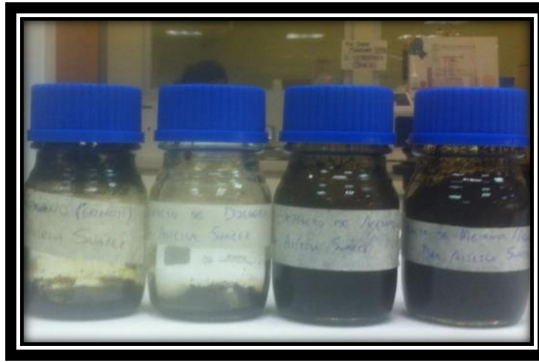
Figura 7. Fracciones de partición de: hexano, diclorometano, acetato de etilo y metanol/agua
