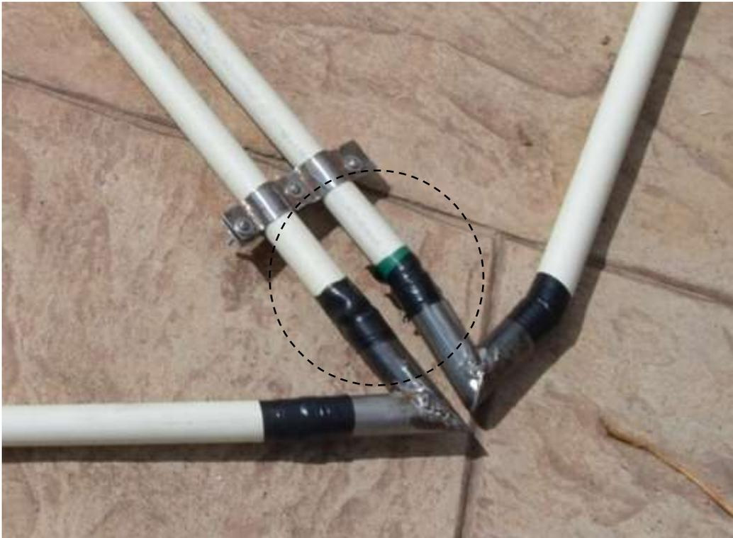
**Figura 90.** Unión de tubo PVC – ángulo de hierro
