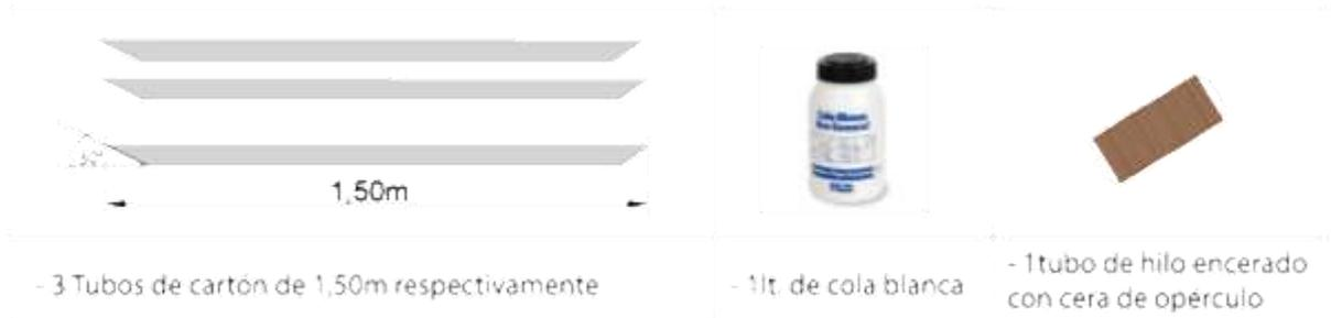
**Figura 142.** Materiales para armado de estructura para cubierta
