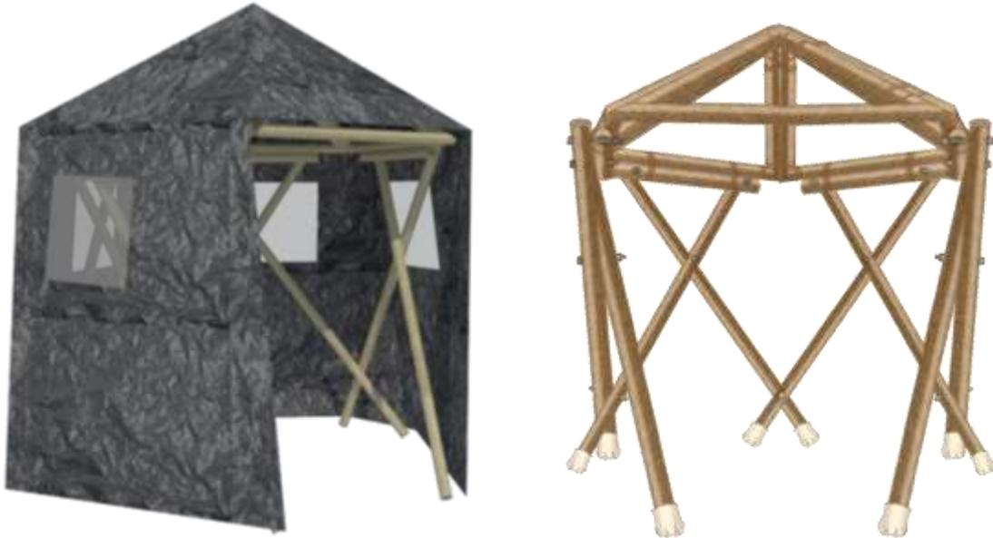
**Figura 128.** Opción de permeabilidad / impermeabilidad dentro del módulo.
