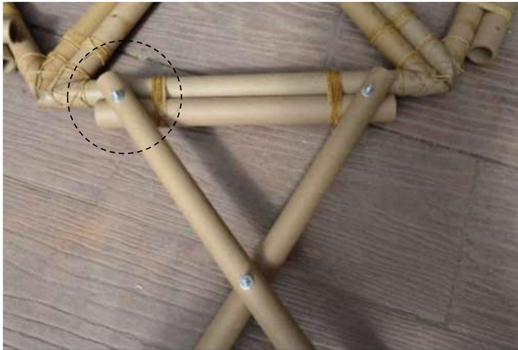
**Figura 103.** Estructura superior y estructura de tijeras unidas
