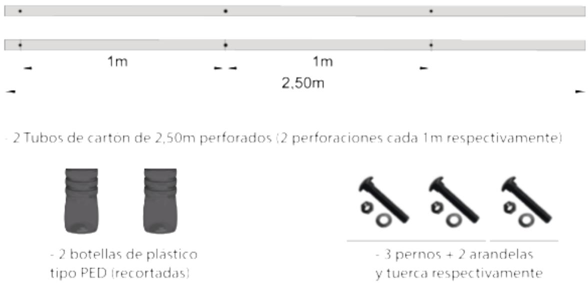
**Figura 152.** Materiales para armado de sistema de tijeras
