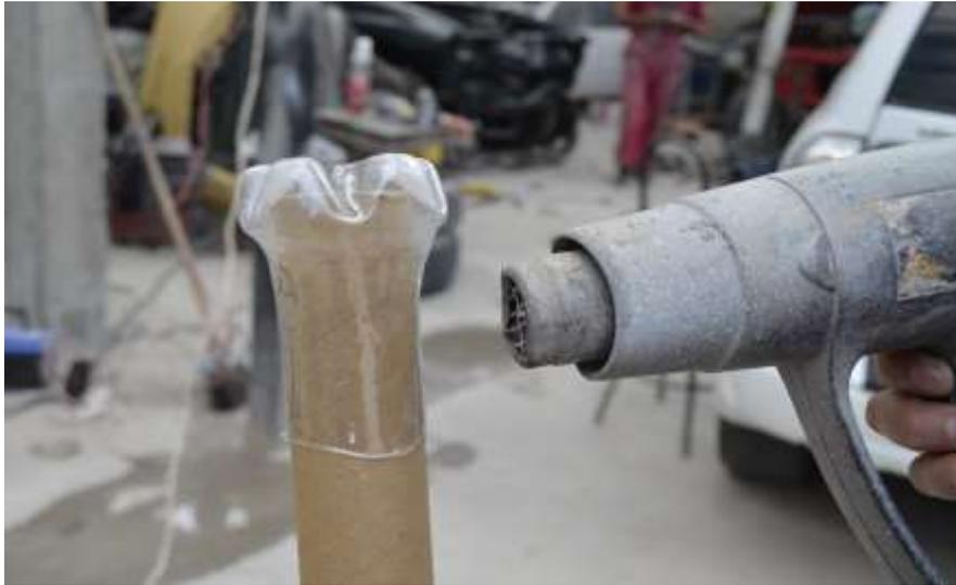
**Figura 106.** Fundición de botellas a tubo de cartón
