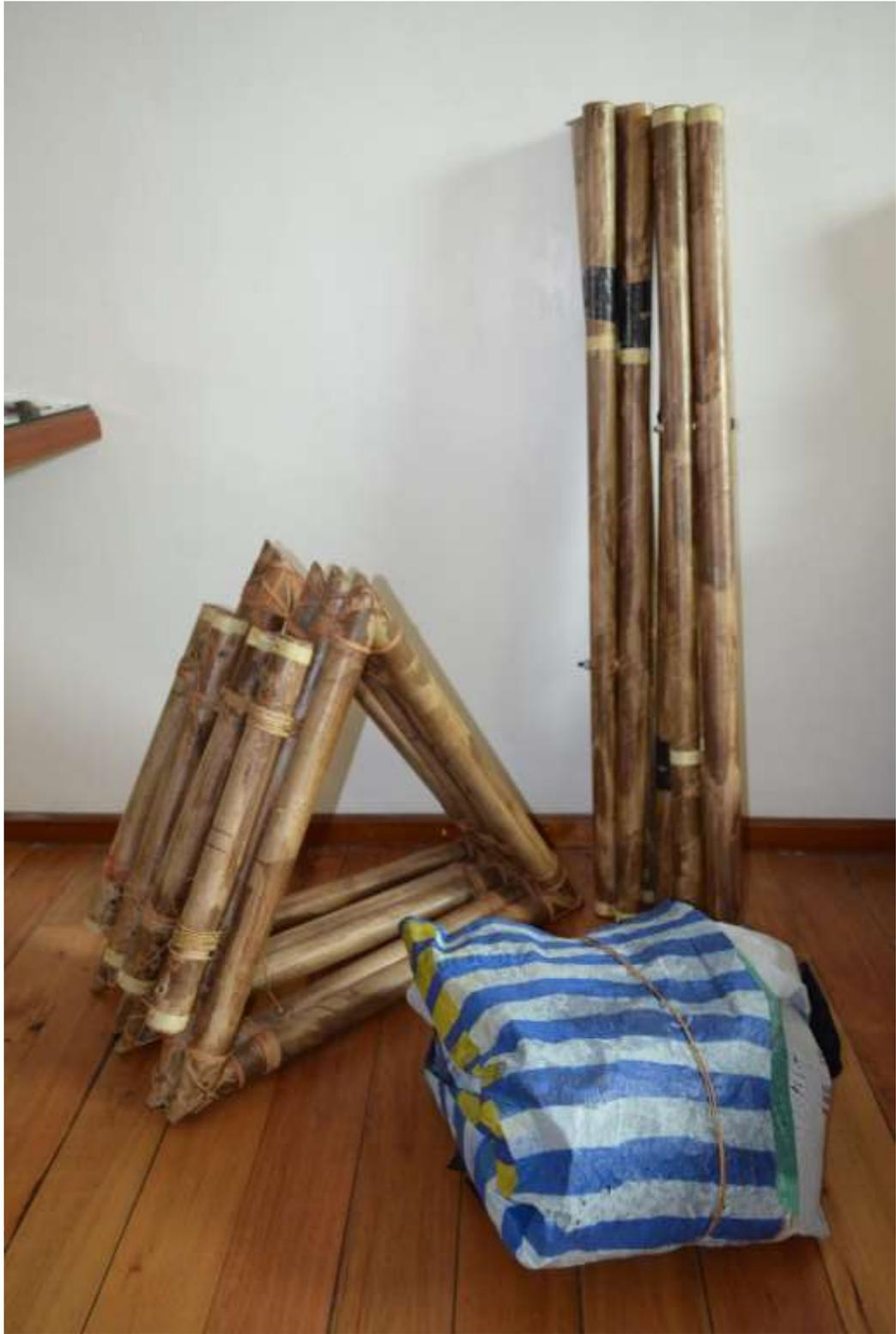
**Figura 159.** Sistema de Plegado para transporte de carpa
