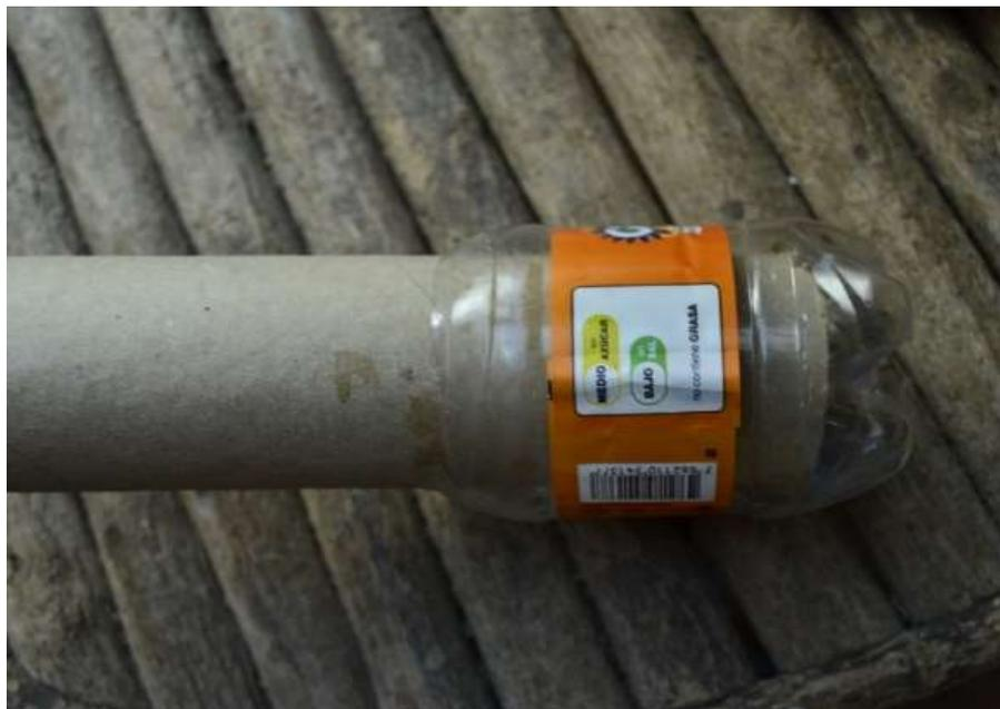
**Figura 105.** Colocación de base de botella en extremo inferior de patas
