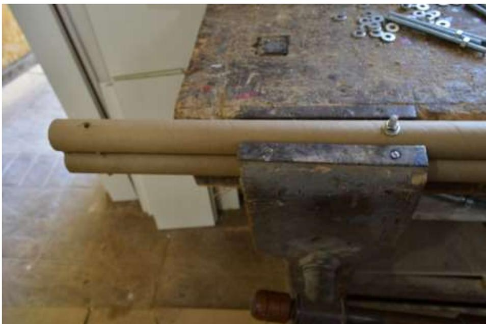
**Figura 101.** Unión de tubos mediante pernos
