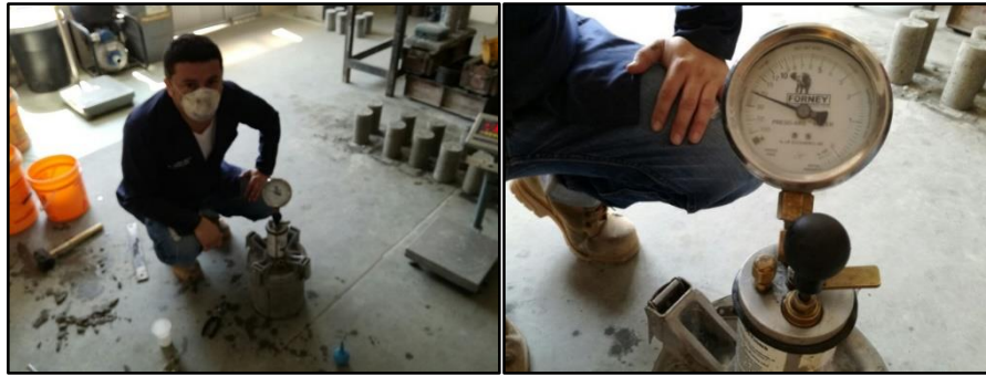
Figura 45. Procedimiento para la obtención del contenido de aire Fuente: El autor Elaborado por: El autor
