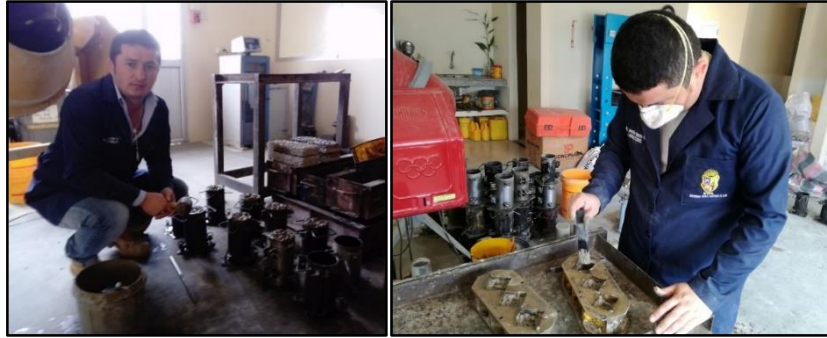
Figura 40. Elaboración de cilindros y cubos para comprobar su resistencia Fuente: El autor Elaborado por: El autor
