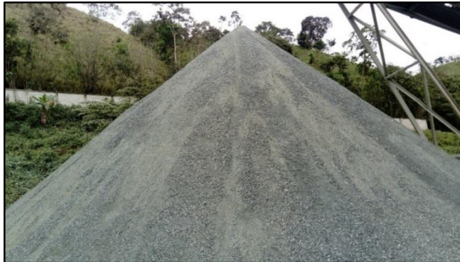
Figura 24. Agregado fino natural para la prueba Z Fuente: Planta de trituración del G.P.A.O. (Panupali) Elaborado por: El autor
