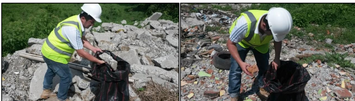
Figura 16 Clasificación manual de residuos de hormigón y mampostería Fuente: Escombrera Pedernales Elaborado por: El autor
