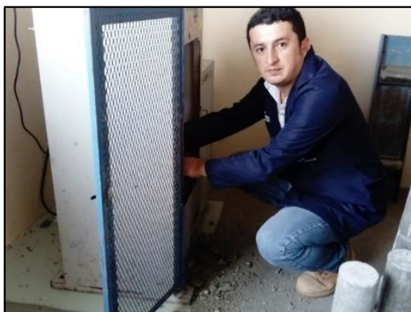
Figura 47. Rotura de cilindros Fuente: El autor Elaborado por: El autor
