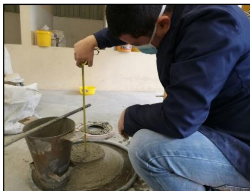
Figura 43. Medición del asentamiento Fuente: El autor Elaborado por: El autor
