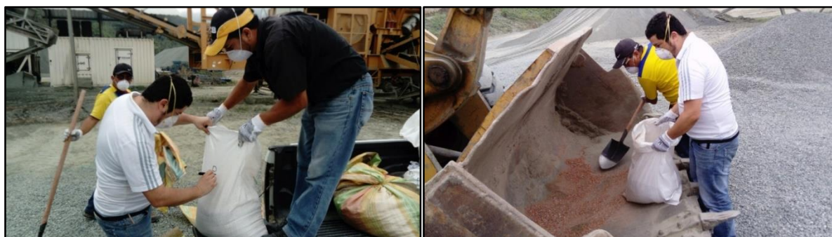
Figura 26. Obtención del AFR de las clasificaciones 1 y 2 Fuente: Planta de trituración del G.P.A.O. (Panupali) Elaborado por: El autor
