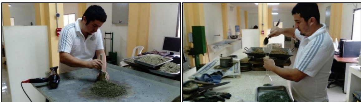
Figura 33. Ensayo de Peso Específico
