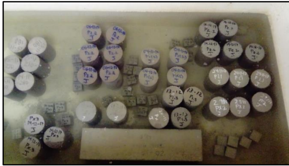
Figura 42. Muestras colocadas en la piscina de curado Fuente: El autor Elaborado por: El autor
