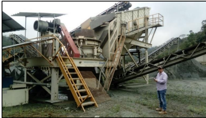
Figura 20. Triturador secundario de cono Fuente: Planta de trituración del G.P.A.O. (Panupali) Elaborado por: El autor
