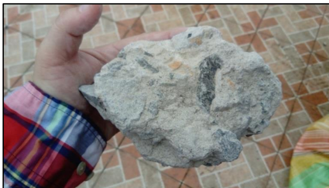
Figura 27. Residuo en que se aprecia el mortero adherido al agregado natural Fuente: El autor Elaborado por: El autor
