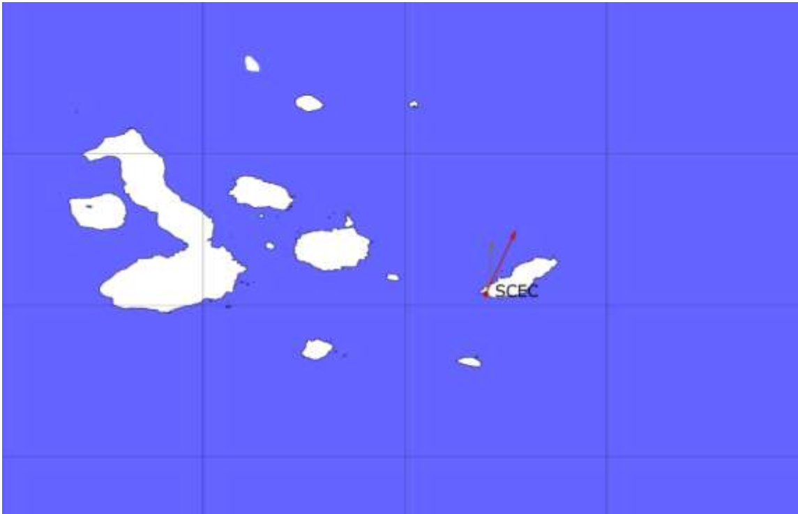
Figura 35: Resultados de las velocidades de desplazamiento de la componente Norte de la estación SCEC, antes y después del sismo
