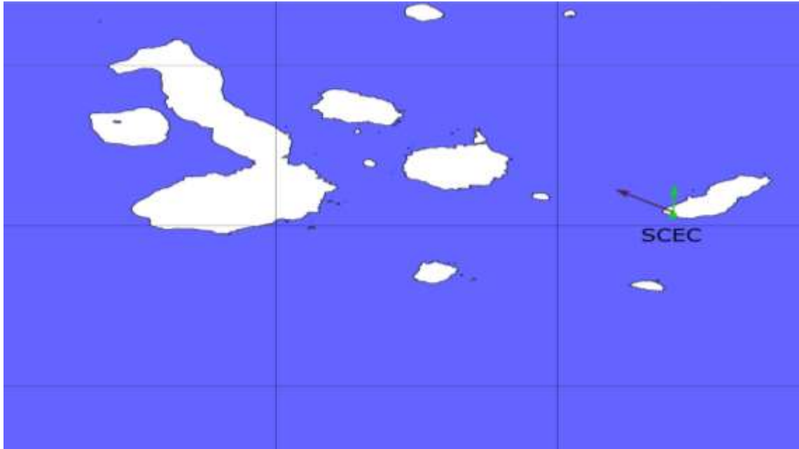
Figura 39: Resultados de las velocidades de desplazamiento de la componente Up de la estación SCEC, antes y después del sismo
