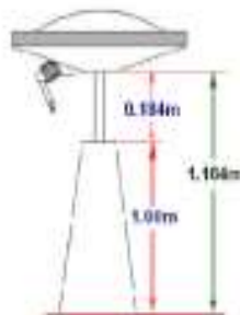
Imagen 3. Esquema de la altura de la antena Fuente: Equipo Técnico REGME – CEPGE
