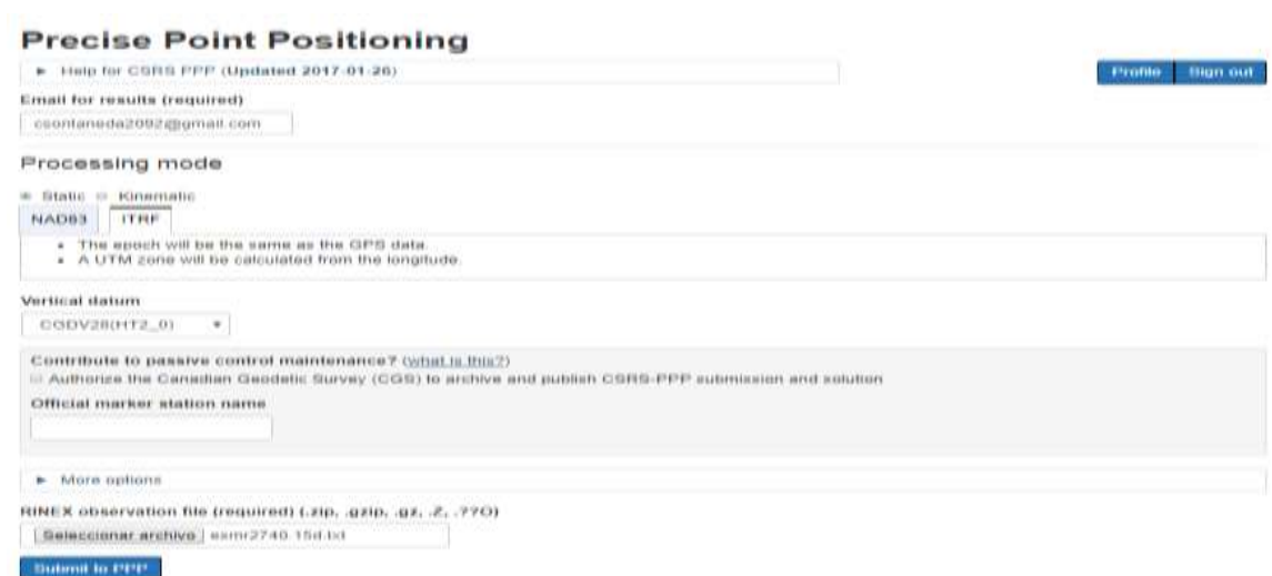
Figura 14: Interfaz para ejecutar el post-procesamiento de los datos RINEX Fuente y Elaboración: (Natural Resources Canada)
