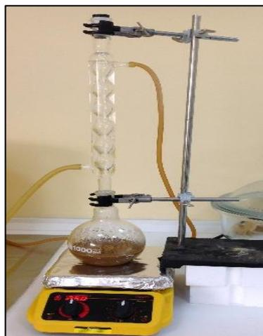
**Figura 8** Sistema de reflujo empleado durante la modificación del mineral.
