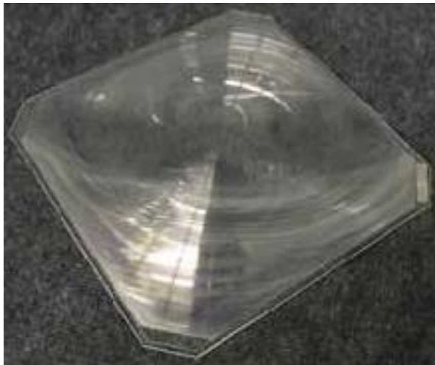
Figura 10. Vista general de la lente de Fresnel a utilizar durante el desarrollo del prototipo.
