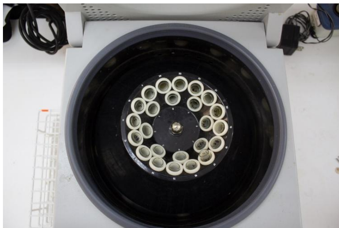
Figura 24 Centrifuga, método de sedimentación Fuente: Autor Elaboración: Autor
