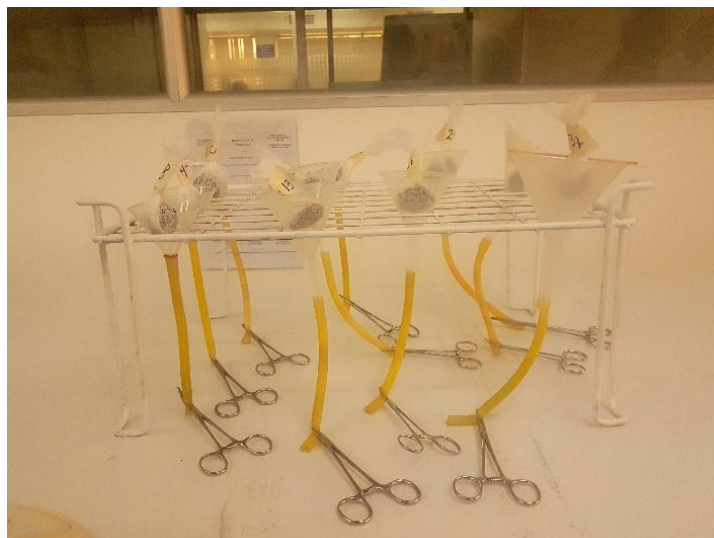
Figura 26 Aparato de Baermann Fuente: Autor Elaboración: Autor
