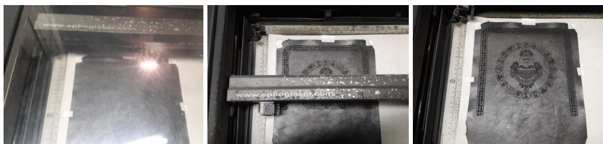
Figura 36. Proceso de grabado en láser. Fuente: Pasinche, Diana, (2018) Elaboración: Autora
