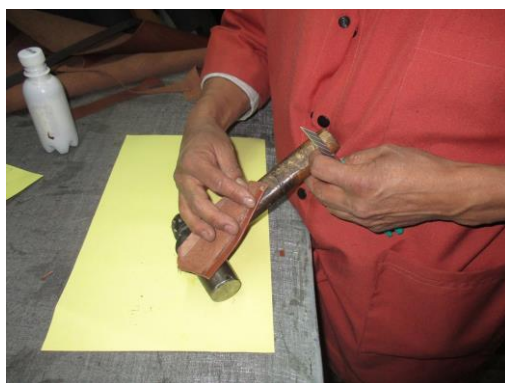
Figura 24. Adelgazamiento de bordes y empalme.
