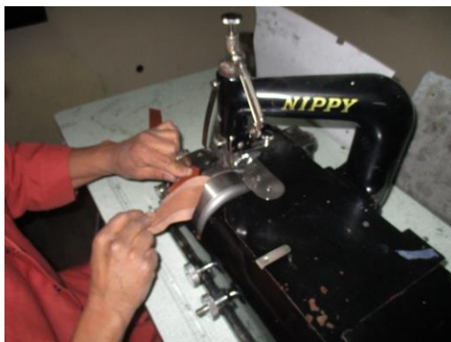
Figura 23. Destallado y virado de las piezas de cuero.
