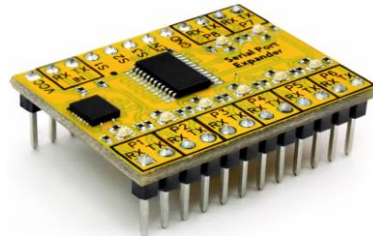
Figura 3.3. Multiplexor de puerto serie 8:1. Fuente: [69]. Elaborado por: [69].
