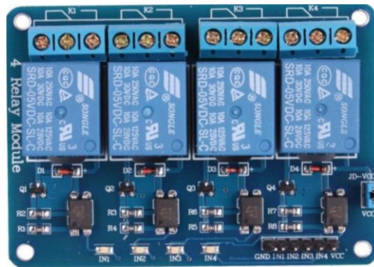
Figura 3.8. Placa de relés para el control de accionamiento. Fuente: Los Autores. Elaborado por: Los Autores.
