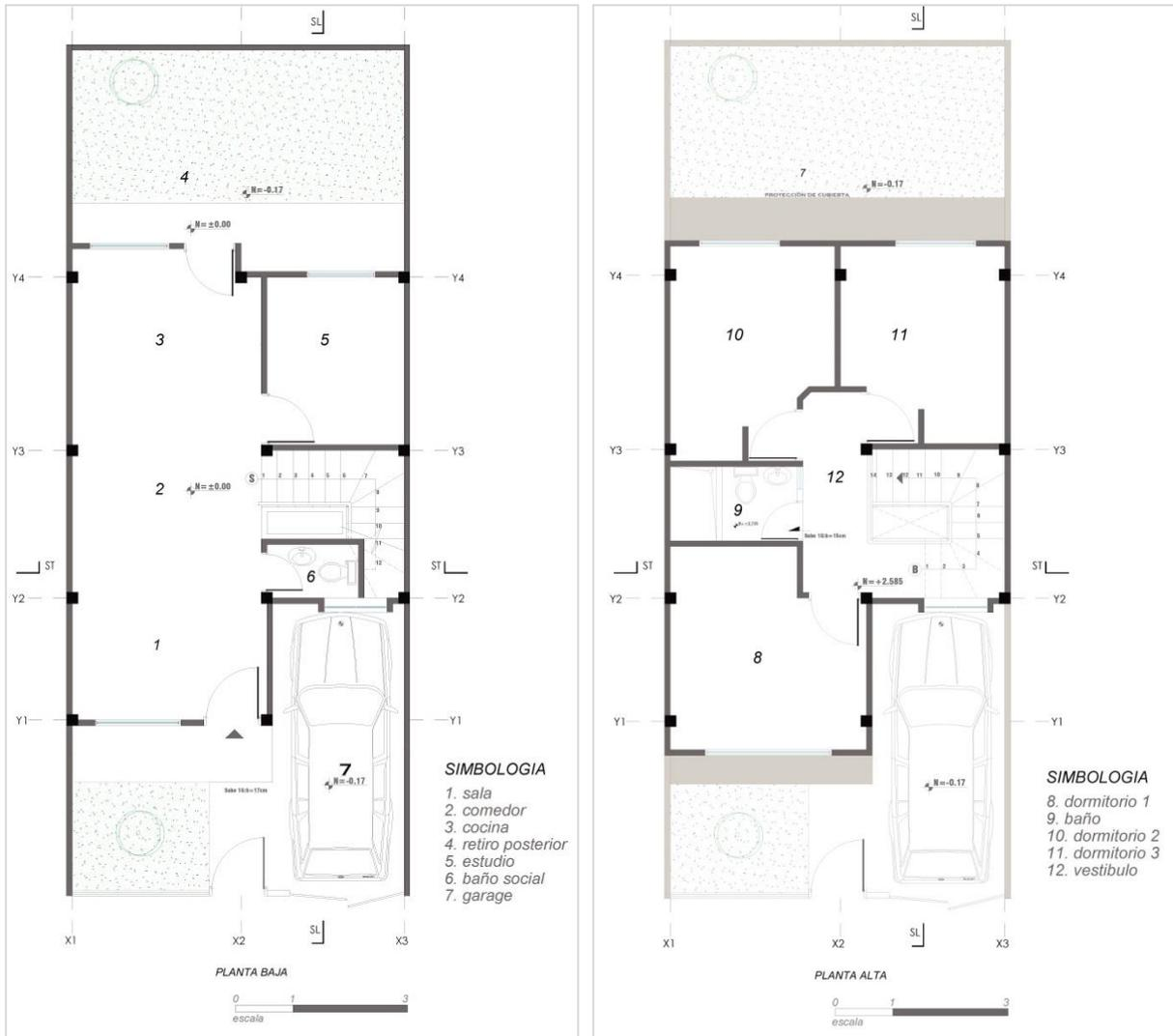
Figura 34. Planta baja y planta alta de la Vivienda tipo
