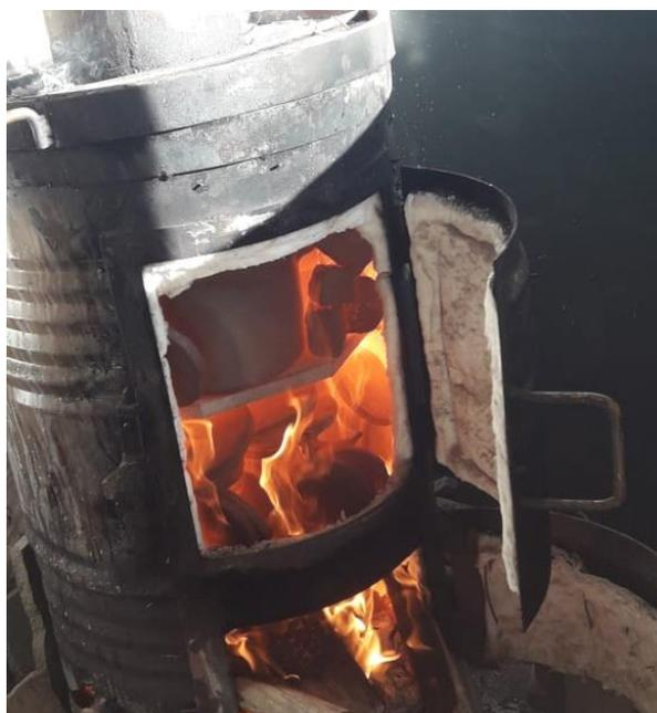
**Figura N° 8.** Horno de leña pequeño, usado para la cocción de las piezas de cerámica
