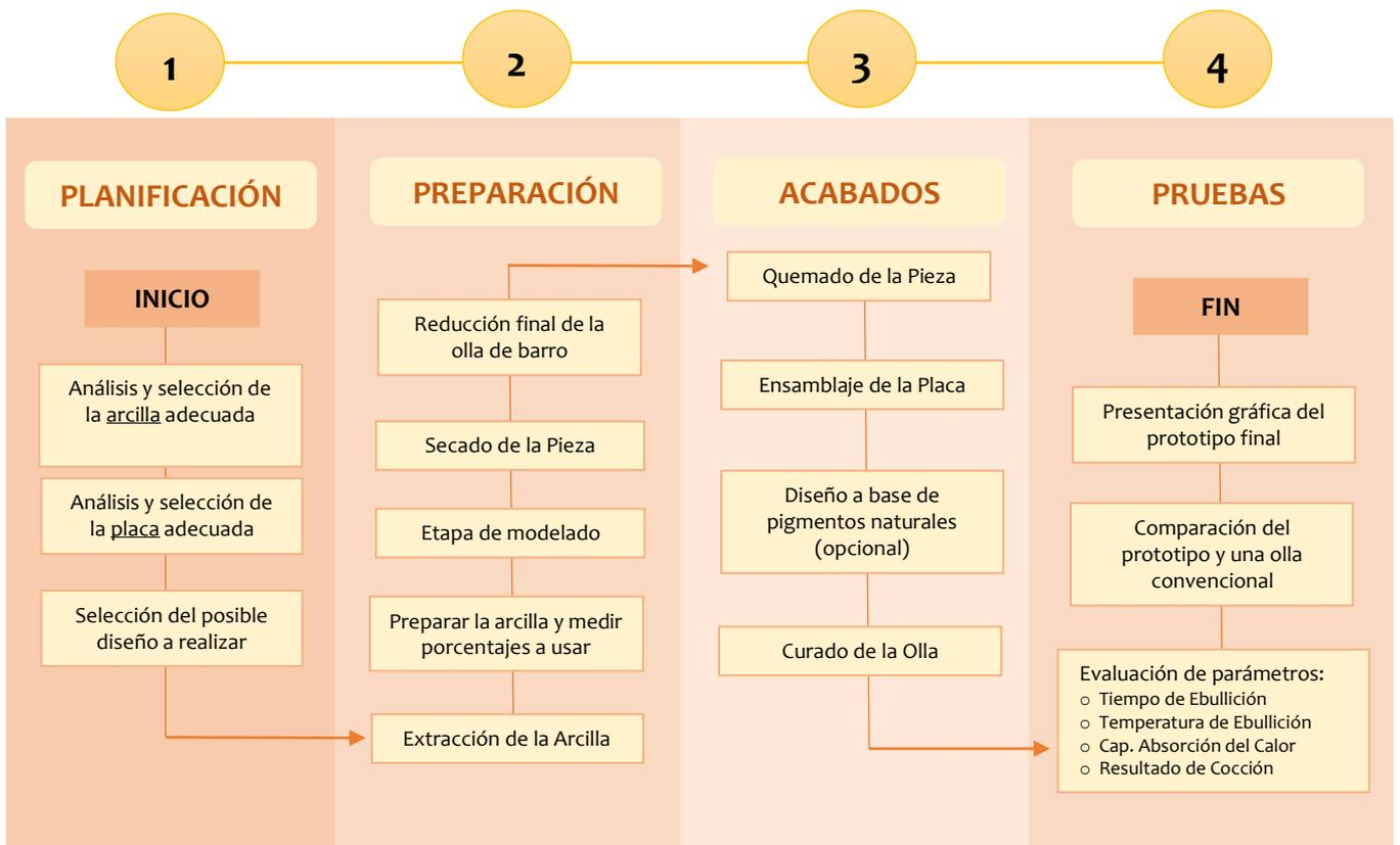
**Figura N° 13.** Resumen del proceso para elaborar el prototipo.
