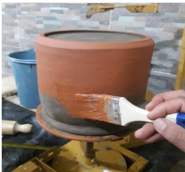
**Figura N° 11.** Dando color al prototipo con el uso de engobe de arcilla roja.
