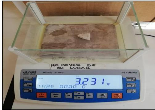
Figura 27. Peso de panel interior con agua
