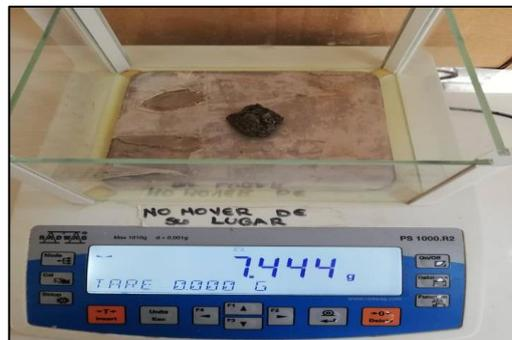
Figura 26. Peso de panel exterior con agua
