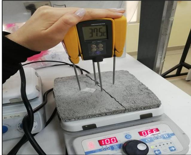
Figura 21. Temperatura del panel exterior con los termómetros
