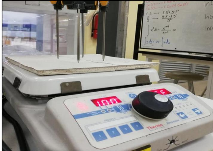
Figura 11. Temperatura del panel Interior con los termómetros
