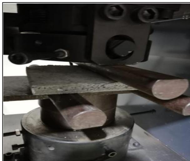
Figura 5. Ensayo de Flexión
