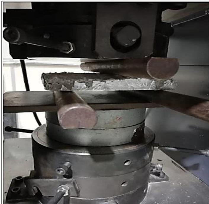
Figura 15. Resistencia a la flexión panel exterior
