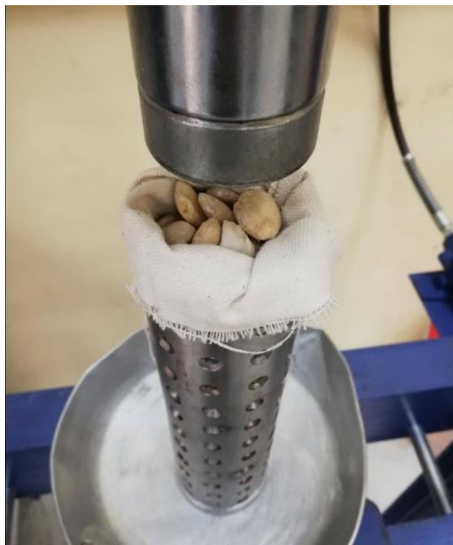
Figura 11. Extracción del aceite vegetal
