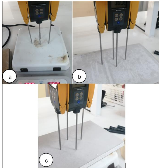
Ilustración 2: Pruebas de conductividad térmica: a) Toma temperatura de la plancha, b) Toma temperatura panel B1, c) Toma temperatura panel de gypsum.
