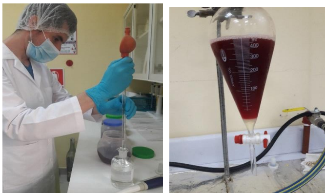
Figura 38: Colocación de diclorometano (horchata). Fuente: Laboratorio de Operaciones Unitarias. UTPL. Elaborado por: El autor
