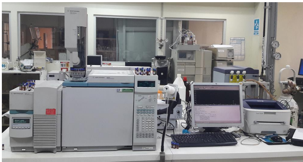
Figura 52: Cromatógrafo de Gases Agilent serie 6890N, acoplada a un Espectrómetro de Masas Agilent serie 5973 Inert.
