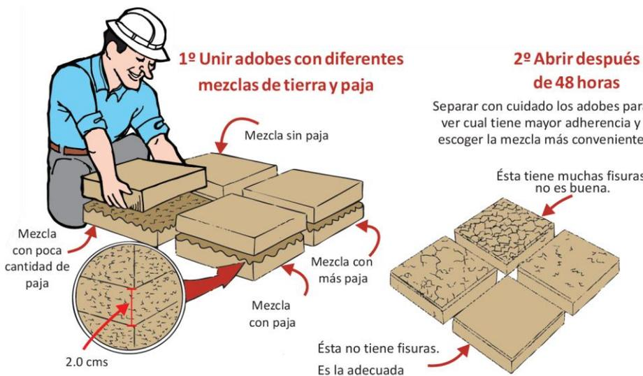
Figura 35. Construcción de muros
