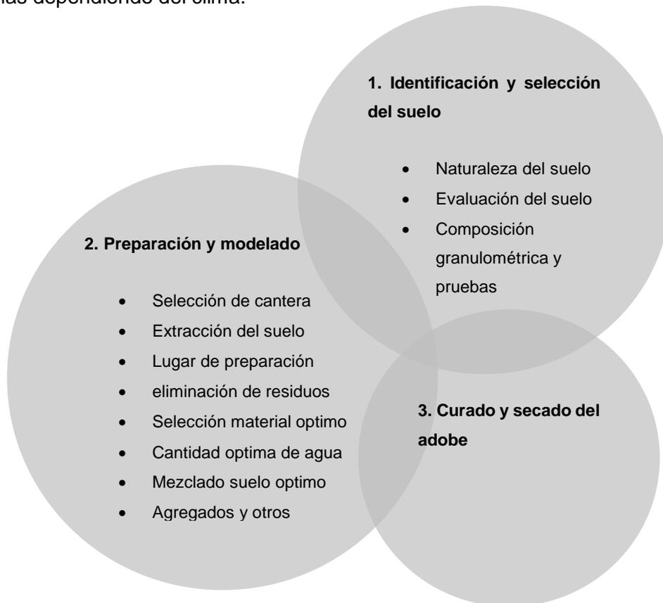
Figura 33. Proceso de fabricación adobe
